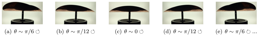
FIGURE 4.8 – Capture de la forme de la coque à différents instants dans le régime de petites oscillations sur la coordonnée \theta pour ( w_0 \simeq 1.85 mm, f = 14.45 Hz).
