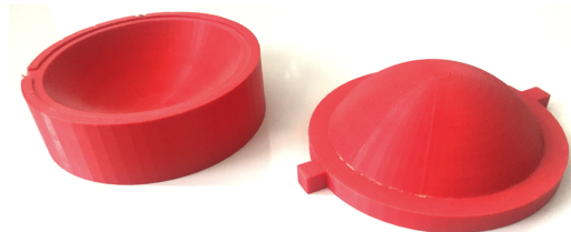
FIGURE 2.7 – Moule en résine plastique fabriqué par impression 3D, de rayon de courbure R = 55 \text{ mm} utilisé pour créer la coque tristable de la figure 2.8.
