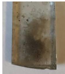
Figure 3 : Photo du dépôt de NiO en milieu éthanol après un recuit à 300^\circ\text{C}/30\text{ minutes}
