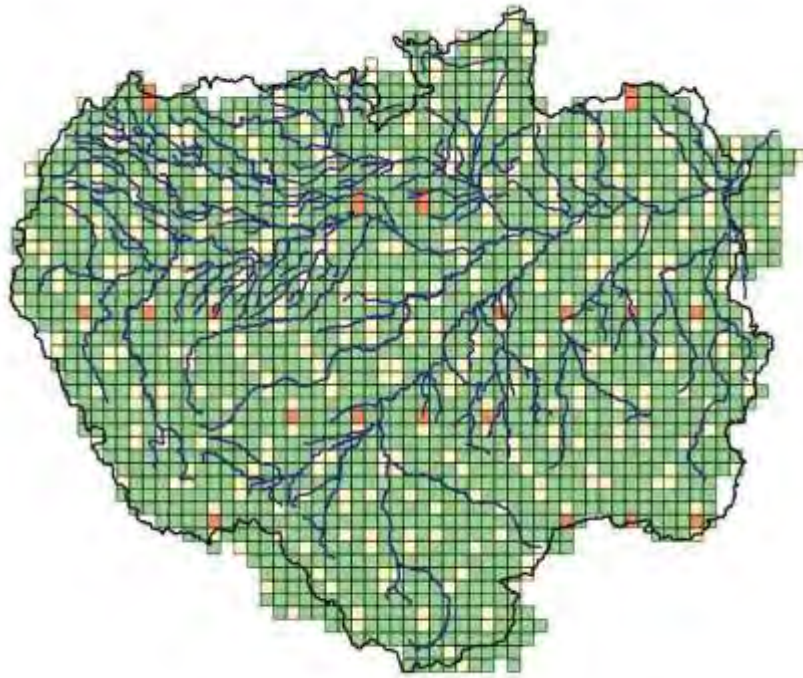
Figure 3.6 – Couverture spatio-temporelle des pseudo-observations SWOT (à la résolution du modèle ISBA-TRIP) sur un cycle de 21 jours : (orange) 0 observation, (jaune) 1 observation, (vert) 2 observations sur le cycle.
