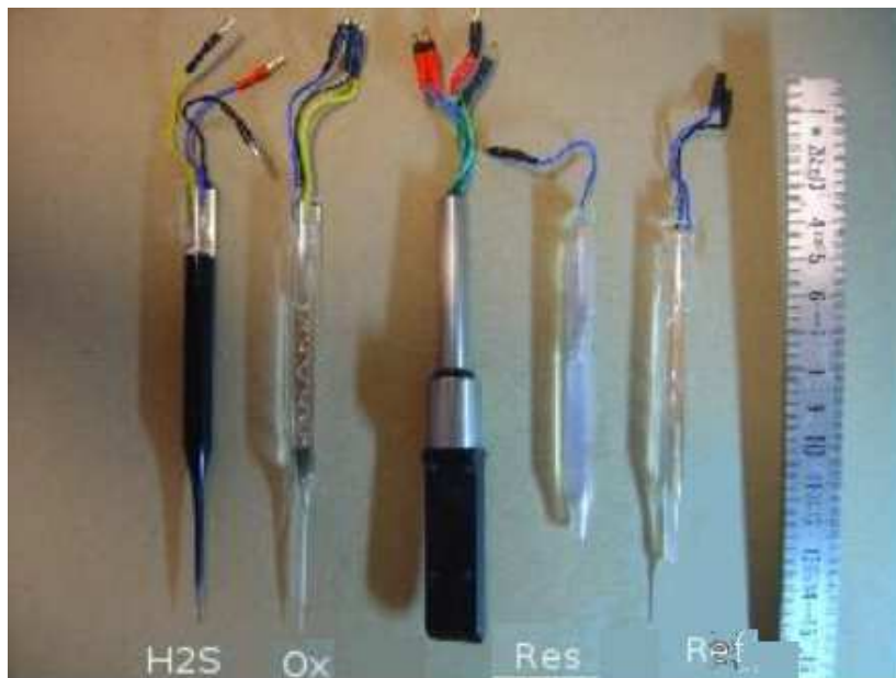
Figure 2.5 – Exemples de microélectrodes utilisées sur le profileur benthique : De gauche à droite : H 2 S, O 2 , résistivité, référence et pH (source : Bruno Bombled)
