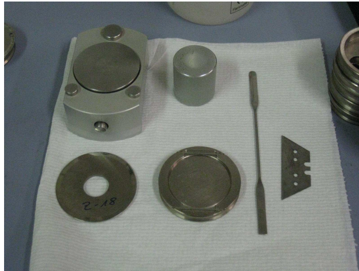
Figure 7.13 – Matériel pour préparer un échantillon de poudre à l'analyse DRX : Portoir de l'échantillon (a) ; plaque de surface (b) ; appui pour le portoir (c) ; piston (d) ; spatule et lame de rasoir (e)
