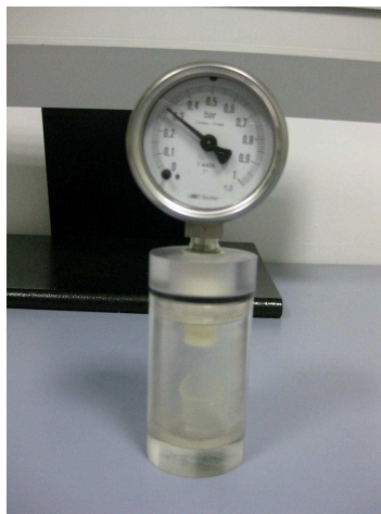
Figure 2.26 – Photo d'un manocalcimètre : Le conteneur est fermé avec un manomètre qui mesure l'augmentation de la pression due à la production de CO_2 résultant de la dissolution de CaCO_3 dans le réacteur.
