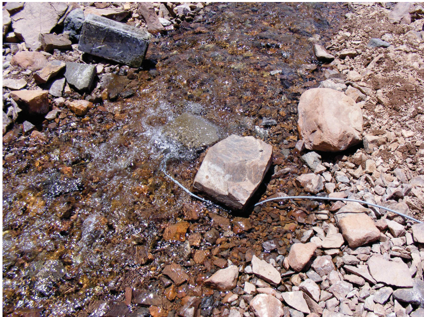
Fluorimètre installé en aval de GFO, abrité sous une pierre
