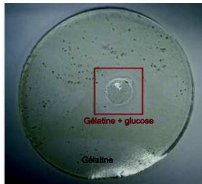
FIGURE 5.21 – Échantillon de gélatine hydratée avec et sans glucose
