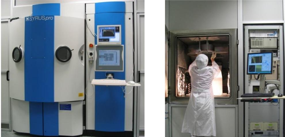
Figure 2-2 : Exemples d'installations réalisant des dépôts couches minces PVD sous vide. Ces équipements sont ceux du laboratoire LZH (Laser Zentrum Hannover, Allemagne) et permettent des dépôts IBS, dont la technique est expliquée dans le paragraphe 2.A.2.iv.
