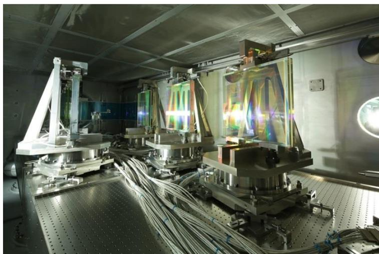
Figure 1-9 : Photographie de l'intérieur du caisson de compression sous vide de l'installation PETAL. Quatre paires de réseaux permettent, dans ce second étage de compression, d'obtenir des impulsions laser de durées inférieures à 1ps. Les réseaux de compression sont bien évidemment positionnés sur des montures motorisées permettant un réglage fin à distance et sous vide. La taille des réseaux est de 450x420mm<sup>2</sup>.
