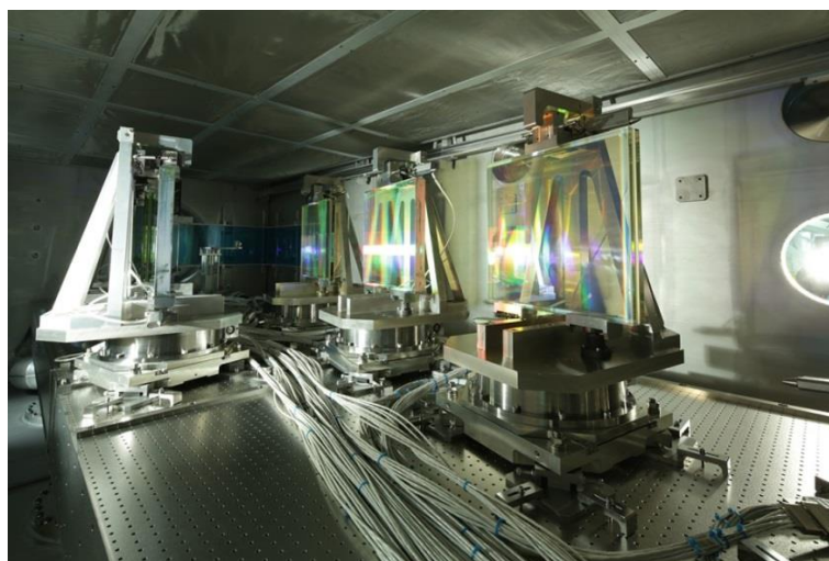
Figure 1-9 : Photographie de l'intérieur du caisson de compression sous vide de l'installation PETAL. Quatre paires de réseaux permettent, dans ce second étage de compression, d'obtenir des impulsions laser de durées inférieures à 1ps. Les réseaux de compression sont bien évidemment positionnés sur des montures motorisées permettant un réglage fin à distance et sous vide. La taille des réseaux est de 450x420mm 2 .
