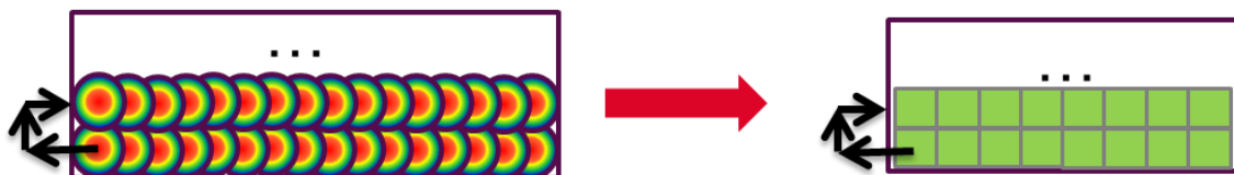
Figure 4-20 : Intérêt de l'utilisation d'un faisceau « top-hat » spatialement pour réaliser le balayage d'une surface avec une fluence homogène.
