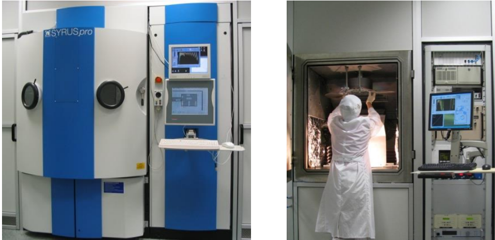
Figure 2-2 : Exemples d'installations réalisant des dépôts couches minces PVD sous vide. Ces équipements sont ceux du laboratoire LZH (Laser Zentrum Hannover, Allemagne) et permettent des dépôts IBS, dont la technique est expliquée dans le paragraphe 2.A.2.iv.
