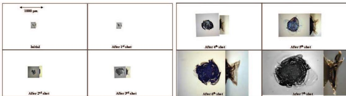
FIGURE 1.20 – Observations par microscopie de la croissance d'un dommage dans un matériau de silice en face arrière. Pour chaque tir, il y a une observation surfacique et l'observation volumique correspondante (effectuée par la tranche de l'optique) (Source [58]).
