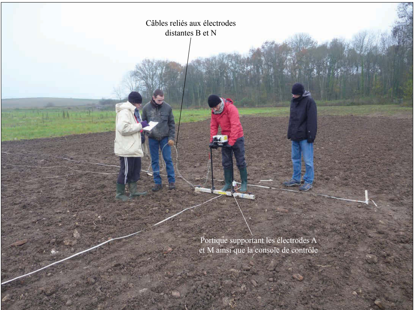
Figure 49 : Acquisition de la résistance en plan à l'aide d'un dispositif pôle-pôle (cliché R. Steinmann)
