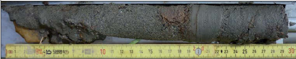
Prélèvement de sédiments préservés entre les pieux de fondation d'une base de moulin sur piles (ensemble 3)
