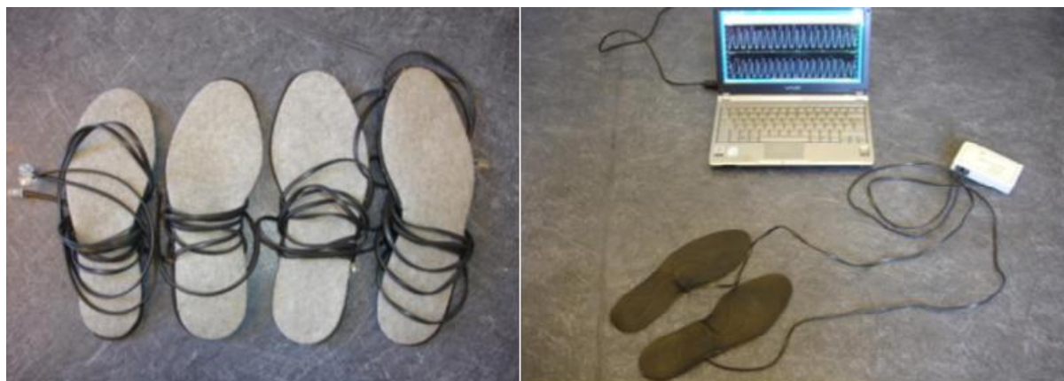
Figure 6. Système d'analyse de marche SMTEC® FootSwitch
