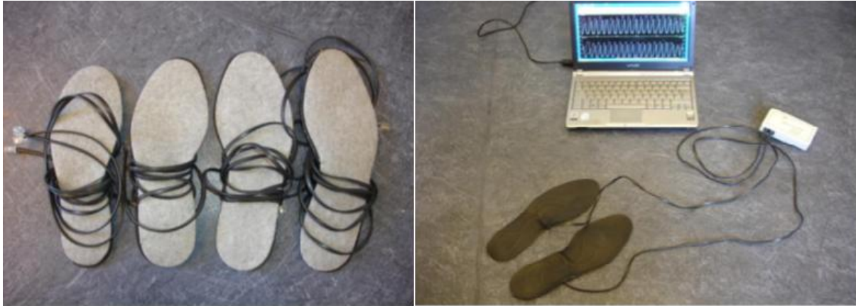
Figure 6. Système d'analyse de marche SMTEC® FootSwitch
