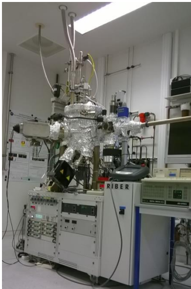
Figure 3 : Photographie et schéma du bâti d'épitaxie par jets moléculaires « Compact12 » utilisé au cours de cette thèse.
