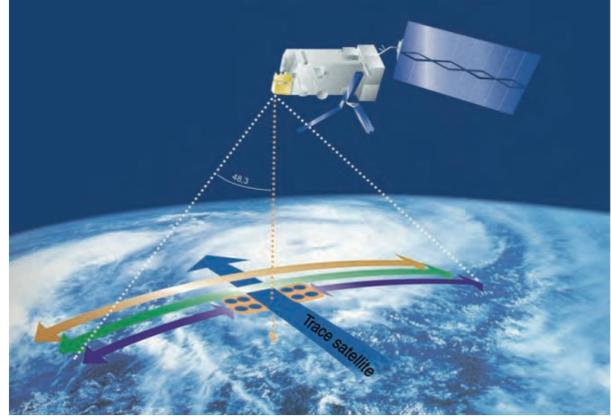
**FIGURE V.1** – Acquisition par balayage transversal et champ de vue des observations IASI. Vue d'artiste du satellite Metop-A. © CNES
