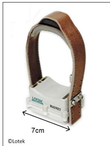
Modèle 3300SL par Lotek® pesant environ 200 grammes et utilisé pour les mammifères de taille moyenne comme les renards.
