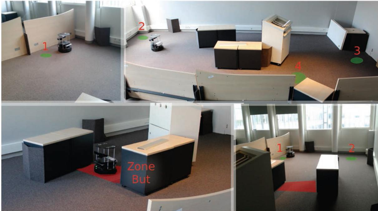
**Figure 8.8 – Arène de l’expérience dans laquelle évolue le robot. Les points verts au sol indiquent approximativement les positions initiales. Bas, gauche : le robot rentre dans l’état 30 (zone but rouge) et reçoit une récompense.**
