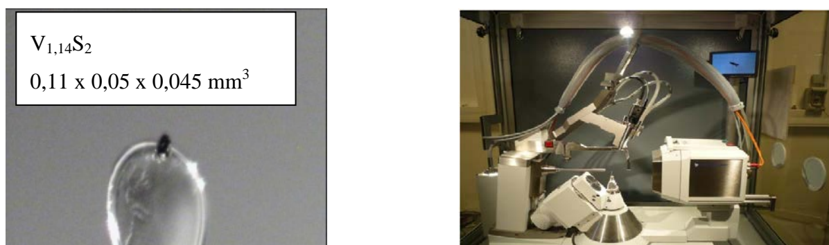
Figure I.4.1: A gauche, montage d'un cristal de VS_2 de dimension 0,11 \times 0,05 \times 0,045 \text{ mm}^3 fixé sur une boucle pour collectionner les données de diffraction sur monocristal. A droite, diffractomètre des rayons X pour monocristal 4 cercles Agilent installé à la Plateforme diffraction-IMPIC.
