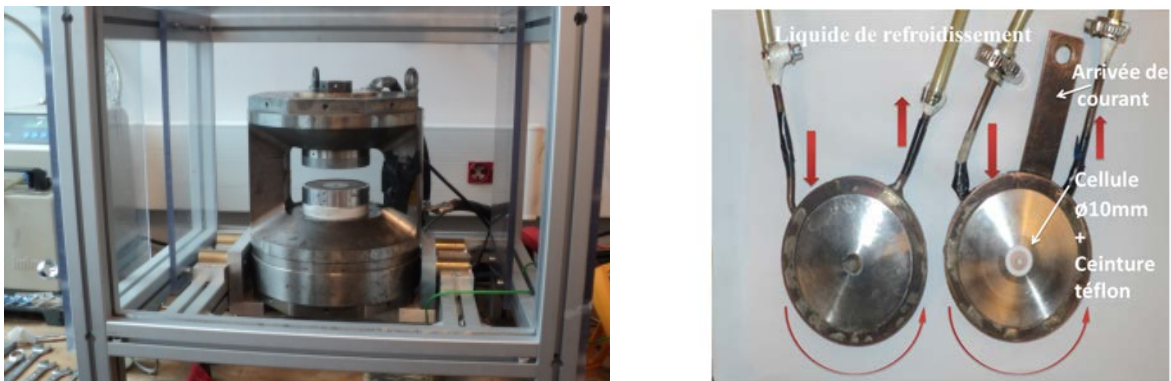
Figure I.3.1.1: Photo de gauche: La presse Paris-Edimbourg VX3 ( Besson 95 et al. et Klotz et al. 33 ) IMPMC, UPMC, Paris. Les deux colonnes sont larges. L'accès à l'enclume se fait par le trou de la culasse. L'optimisation du pot de presse a été réalisée par une modélisation par éléments finis, de manière à minimiser les déformations au niveau du joint d'étanchéité et de la bague de centrage. Photo de droite: Enclume CW frettée de diamètre 3,5mm pour joint biconique de diamètre 10 mm fixée à un refroidisseur et à une arrivée de courant. Les formes de l'enclume du joint contenant l'échantillon sont conçues pour assurer une pression quasi-hydrostatique dans la partie intérieure du joint. Celui-ci est posé sur l'enclume de droite.
