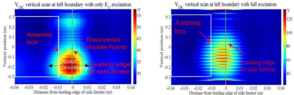
Figure E.2. Carte Verticale-radiale de  $V_{DC}$  à l'extérieur du limiteur d'antenne gauche, pour 1 MW couplés, simulations SSWICH-FW/RAPLICASOL multi-2D, sans inclure d'effet 3D. (Gauche) simulations excitées uniquement avec la composante  $E_{//}$ , de la carte de champ RF issue RAPLICASOL 3D. (Droite) simulations réalisées avec toutes les polarisations de la carte de champ RF.
