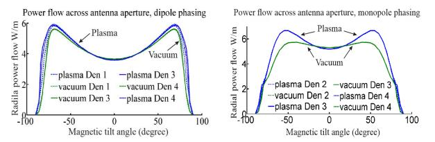
Figure E.1 : Puissance transmise au plasma central, pour 1A dans 1m de ruban, en fonction de l'angle d'inclinaison du champ magnétique par rapport à la direction toroïdale, pour différentes formes de profils de densité dans la boîte d'antenne. (a) Simulation pour deux rubans de géométrie Tore Supra dont les courants RF oscillent en opposition de phase (phasage « dipôle ») ; (b) idem pour des courants RF en phase (phasage « monopôle »)
