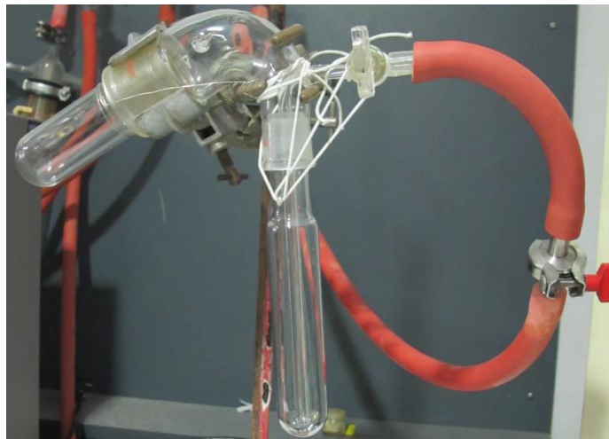
Figure 11 : montage de désorption à l'arrêt. Le PDMS est placé dans le tube oblique à gauche ; les espèces désorbées sont collectées dans le tube vertical au centre.
