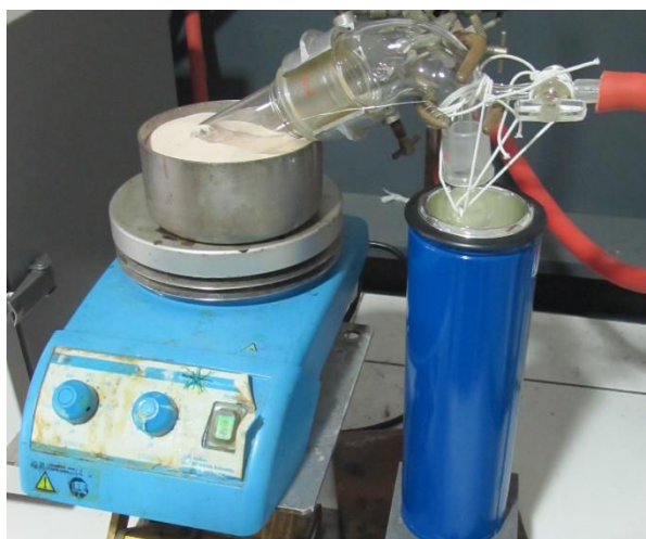
Figure 12 : montage de désorption représenté en fonctionnement
