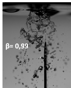
FIGURE 6.12 – Mesure au point "stripping" pour le jeu de paramètres ( U_{lsup} = 0,17 \text{ m/s} ; U_{gext} = 20 \text{ m/s} ) (set 1) - \beta = 0,99 (Régime d'écoulement interne : Annulaire) - géométrie gros diamètre avec convergent - M = 16
