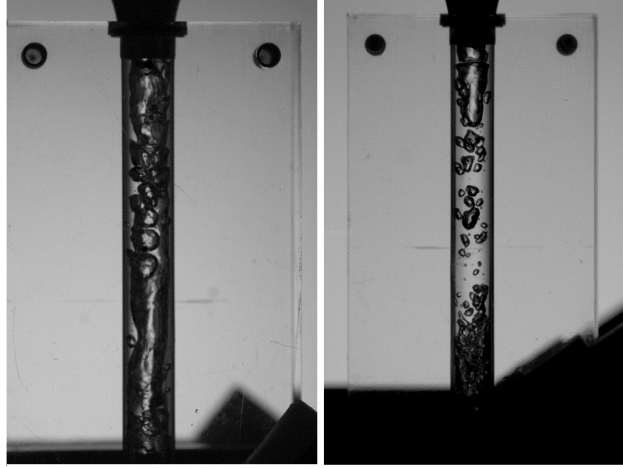
FIGURE 6.44 – Écoulement de type "churn" pour les géométries avec (à gauche) et sans (à droite) convergent - U_{l\text{sup}} = 0,61 m/s et U_{g\text{ext}} = 71 m/s
