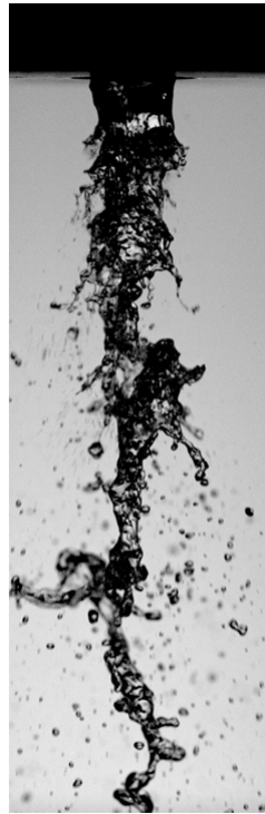
FIGURE 4.6 – U_l = 0,36 \text{ m/s} ; U_{gext} = 43 \text{ m/s} ; \beta = 0 - M = 16 - géométrie gros diamètre avec convergent.
