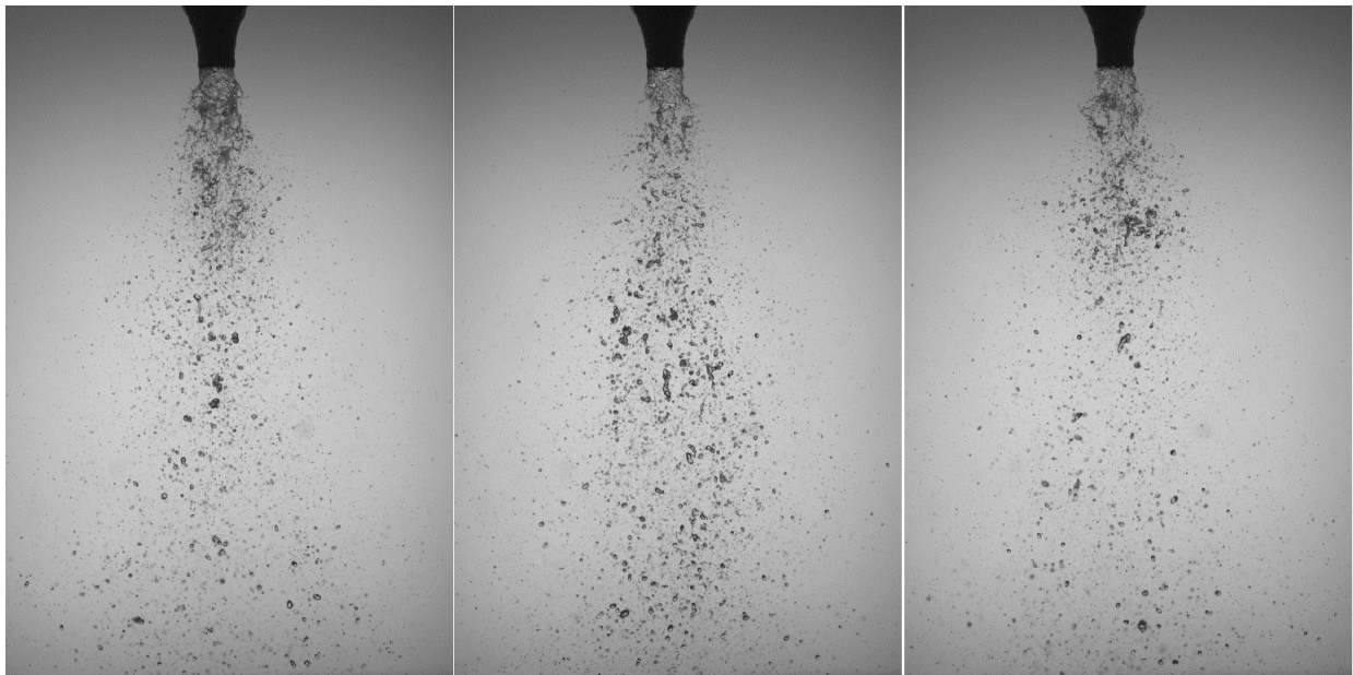
FIGURE 4.21 – Écoulement annulaire sortant de l’injecteur sans présence de gaz externe - U_{l\text{sup}} = 0,36 m/s, \beta = 0,99 , U_{g\text{int}} = 36 m/s - Géométrie gros diamètre avec convergent.
