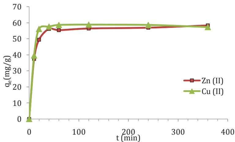
III-11 Cinétique d'adsorption d'ions de cuivre et zinc par NPM\_DVB.
