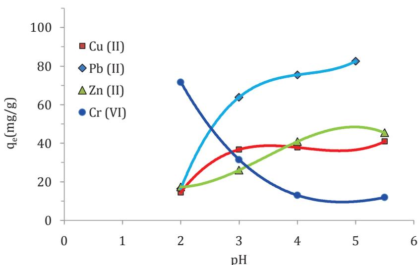
III-7. Effet du pH initial de milieu sur le phénomène d'adsorption de *NPM\_AD*.
