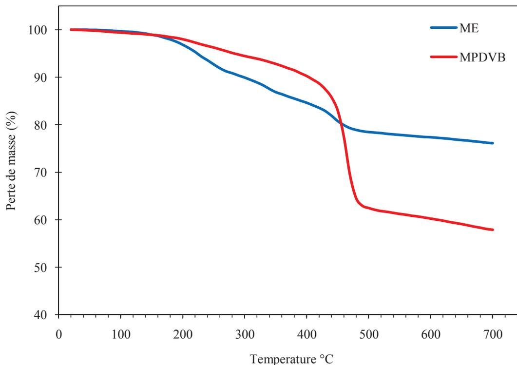
III-6. Variation de masse observée lors de l'analyse thermogravimétrique du latex MP-DVB et de l'émulsion magnétique sous atmosphère N<sub>2</sub> avec une rampe de température de 10°C/min
