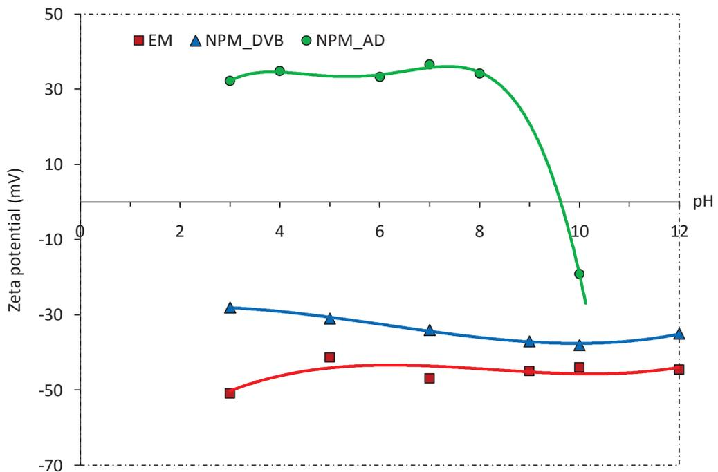
III-3. Potentiels Zeta de l'émulsion magnétique (EM) et celle des particules magnétiques *NPM\_DVB* et *NPM\_AD* en fonction du pH
