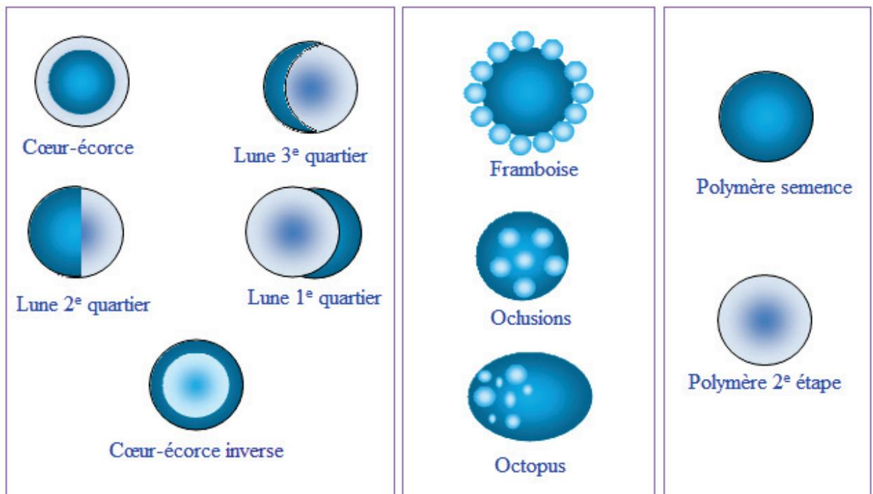
Figure IV- 4. Exemple de morphologies de particules décrites dans la littérature.
