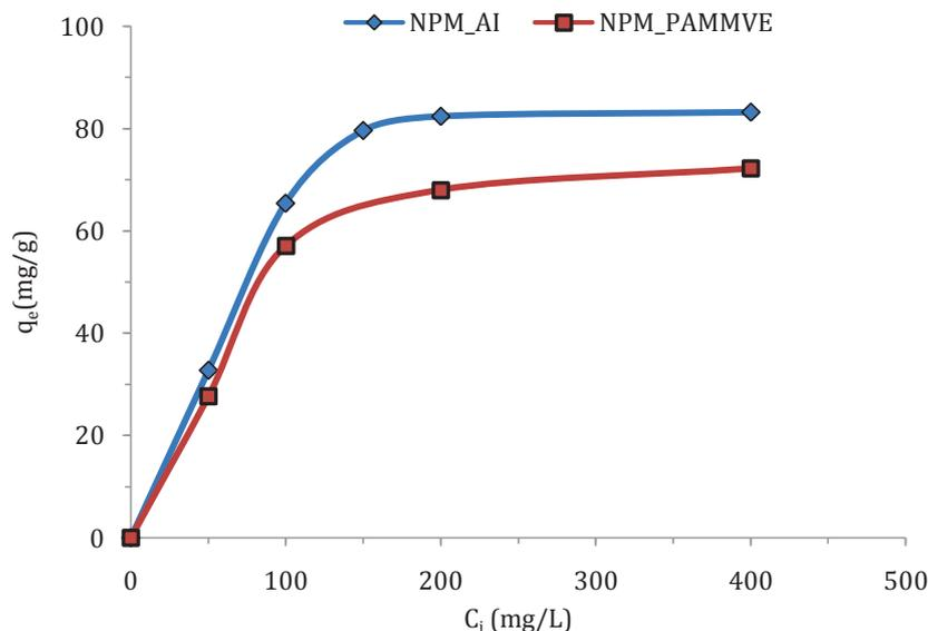
III-17. Effet de la concentration initiale de Cu<sup>2+</sup> sur l'adsorption de NPM\_AI et NPM\_PAMMVE.
