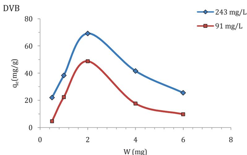
III-2. Effet de la dose de NPM\_DVB (à 91 mg/L et à 243 mg/L) sur l'adsorption de BPA.
