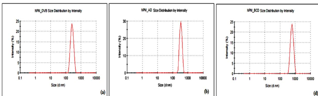
III-3. Répartition de la taille hydrodynamique des particules (a) NPM\_DVB, (b) NPM\_AD, et (d) NPM\_CD.
