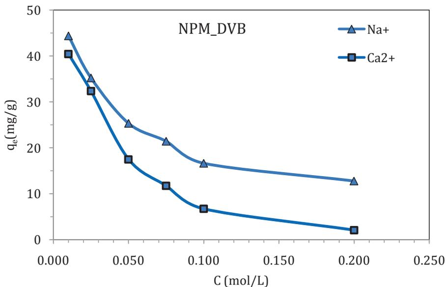
III-9. Effet de la présence de l'ion commun sur l'adsorption d'ions de cuivre par *NPM\_DVB*.
