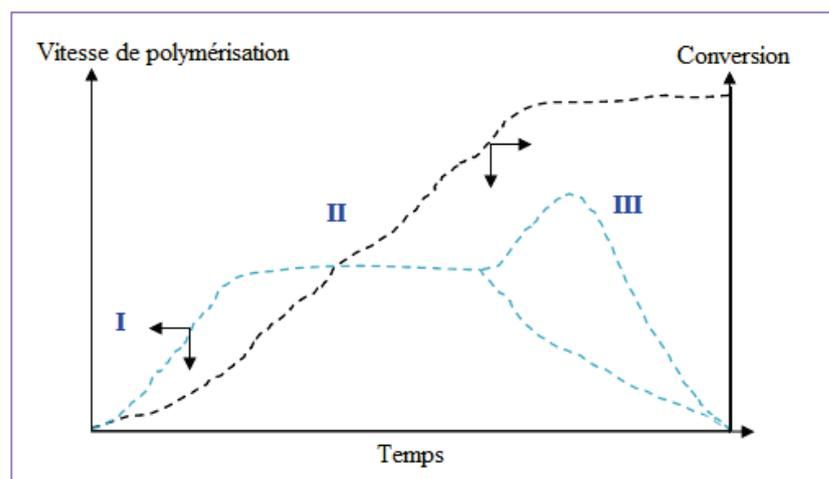
Figure IV- 1. Courbes de conversion et de vitesse de polymérisation en fonction du temps dans une polymérisation en émulsion.
