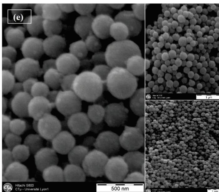
III-2. Observation microscopique électronique à balayage (MEB) de NPM\_CD.
