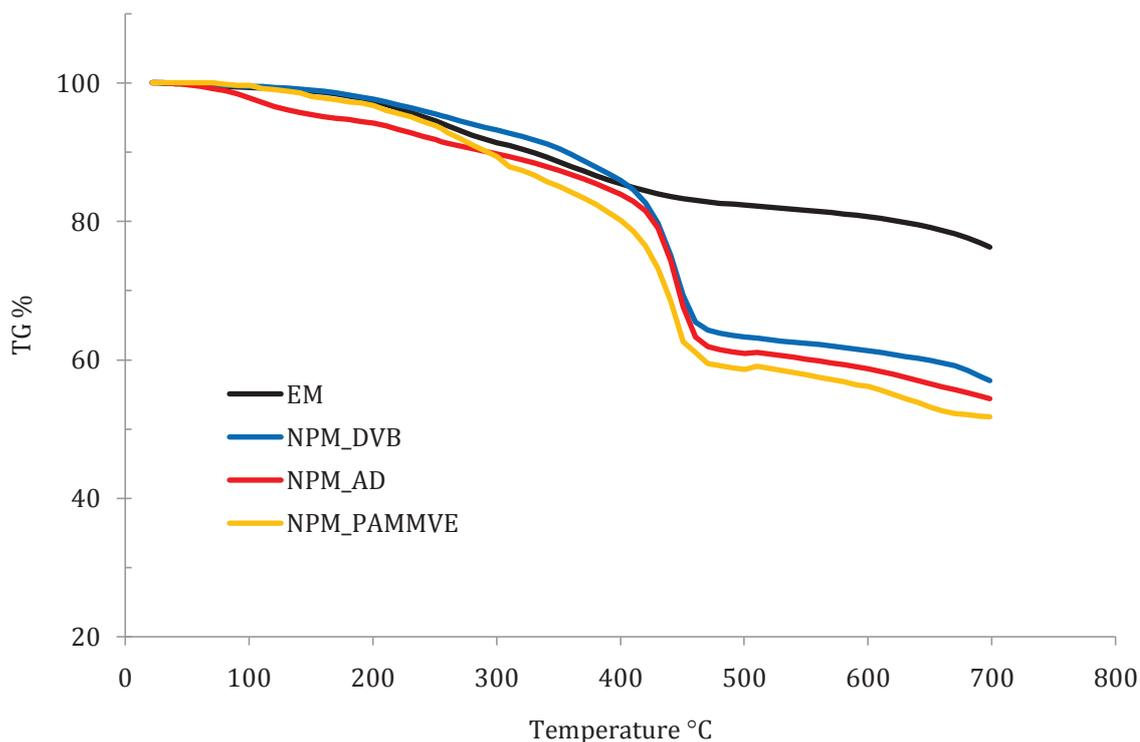
III-10. Variation de masse observée lors de l'analyse thermogravimétrique de l'émulsion magnétique (EM), de NPM\_DVB, NPM\_AD et celle de NPM\_PAMMVE sous atmosphère N<sub>2</sub> avec une rampe de température de 10°C/min (Netzsch TG 209 F1).
