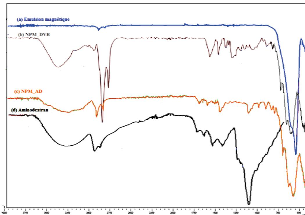
III-4. Spectre infrarouge de (a) émulsion magnétique, (b) *NPM\_DVB*, et (c) *NPM\_AD* et celle (d) de l'aminodextran (FTIR, IR Prestige-2, Shimadzu).
