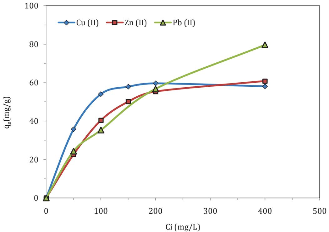
III-12 Effet de la concentration initiale de cuivre, plomb et zinc sur l'adsorption de *NPM\_DVB*.
