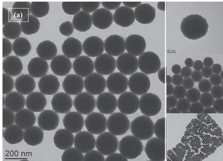
**III-2. Observation microscopique électronique à transmission (MET) de l'émulsion magnétique.**
