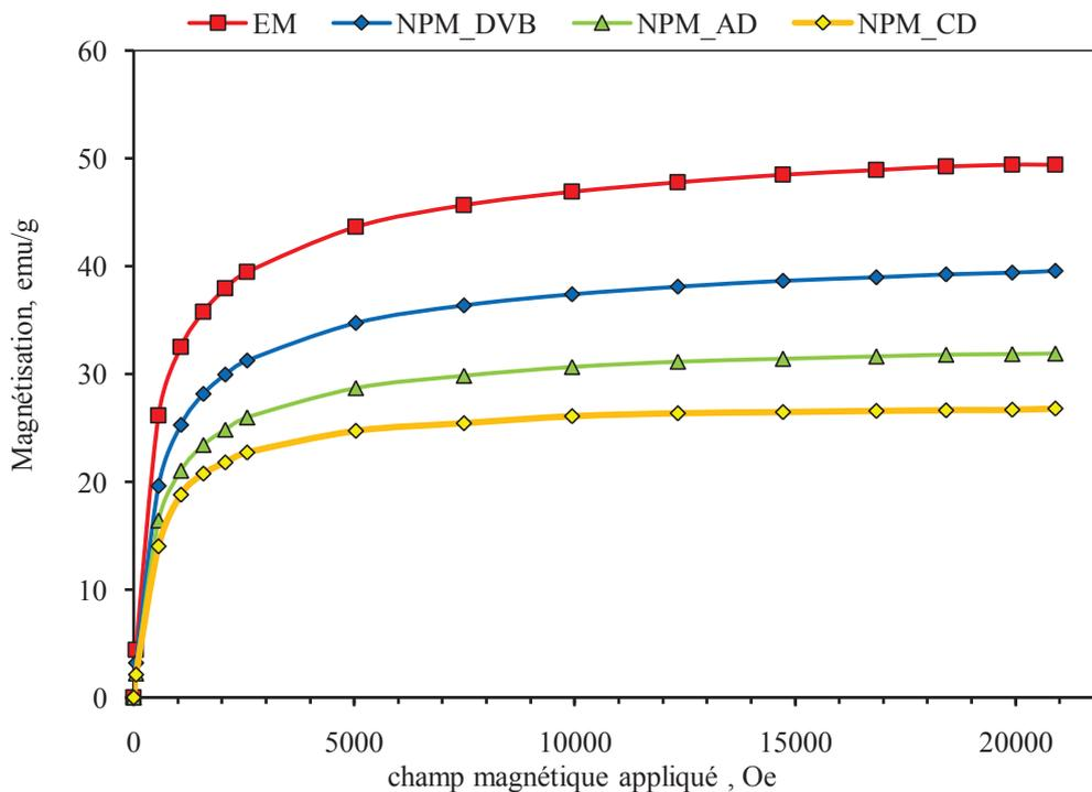
III-1. Courbe d'évolution de la magnétisation en fonction du champ magnétique pour les particules magnétiques synthétisées.
