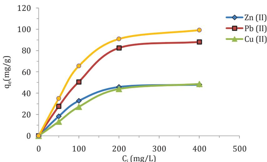
III-10. Effet de la concentration initiale de cuivre, plomb, zinc et chrome sur l'adsorption de  $NPM\_AD$ .
