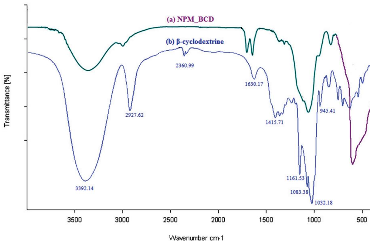
III-5. Spectre infrarouge de (a)  $\beta$ -cyclodextrine et (b) particules magnétiques fonctionnalisées par  $\beta$ -cyclodextrine NPM\_CD (Agilent technologies Cary 630 FTIR).
