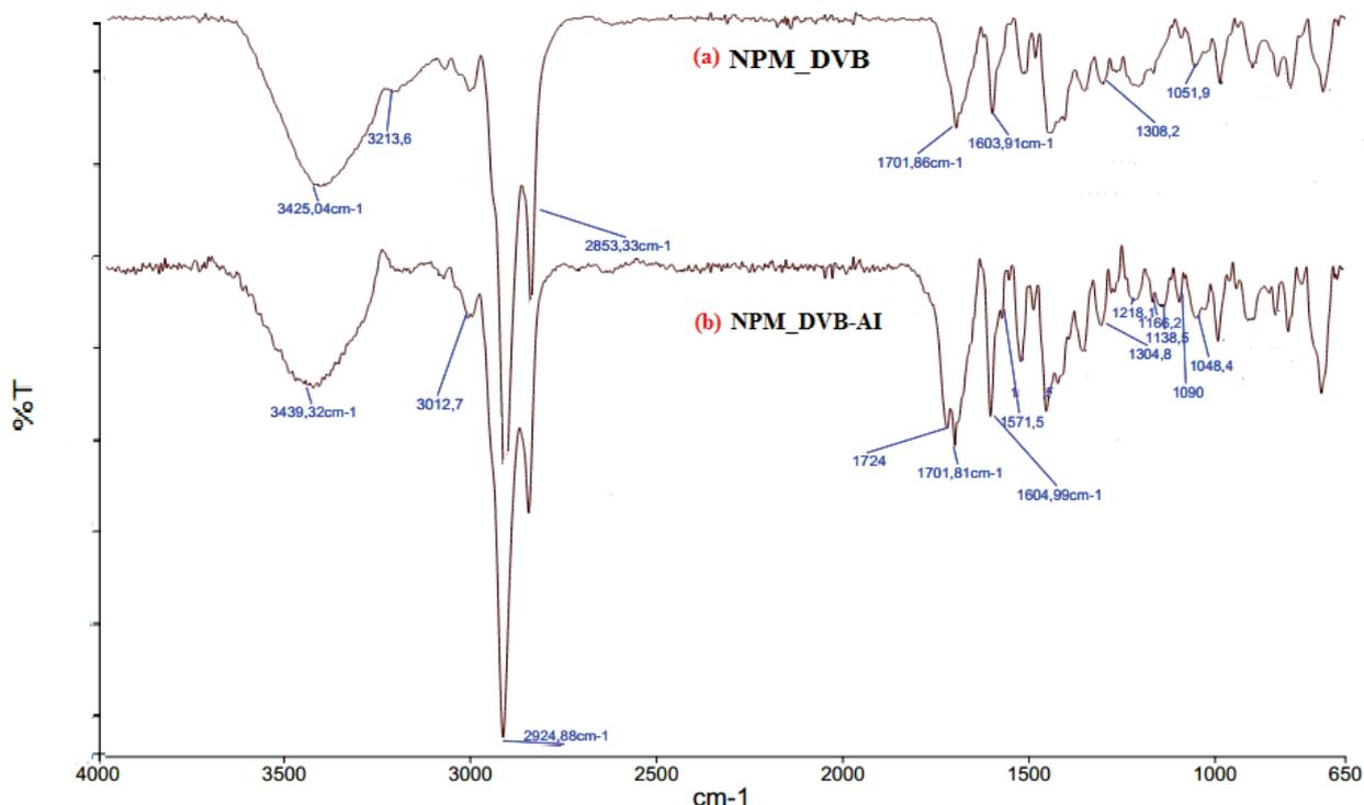
III-7. Spectre infrarouge des particules magnétiques (a) *NPM\_DVB* et (b) *NPM\_DVB-AI* (Perkin Elmer Spectrum Version 10.00.00).
