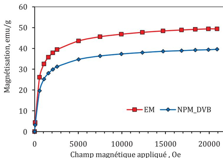
III-1. Courbe d'évolution de la magnétisation en fonction du champ magnétique pour les particules magnétiques synthétisées.
