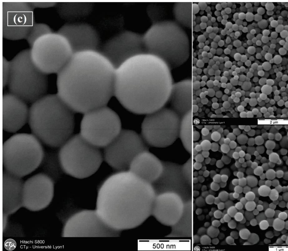
III-2 Observation microscopique électronique à balayage (MEB) de *NPM\_AD*.
