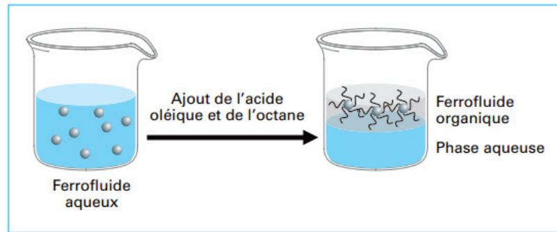
II-1. Transfert de phase de nanoparticules d'oxyde de fer dispersées dans une phase aqueuse en phase organique [64].
