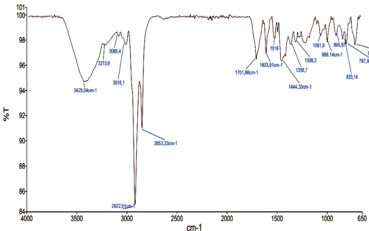
III-5 Spectre infrarouge des particules NPM\_DVB
