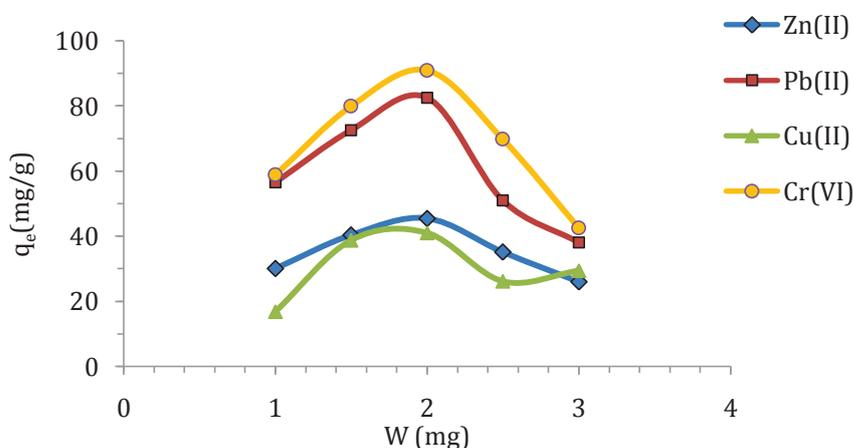
III-6. Effet de la dose de NPM\_AD sur l'adsorption d'ions de cuivre, plomb, zinc et chrome.
