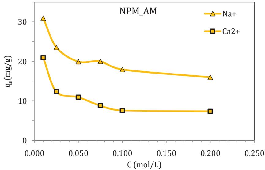
III-8. Effet de la présence de l'ion commun sur l'adsorption d'ions de cuivre par NPM\_AD.
