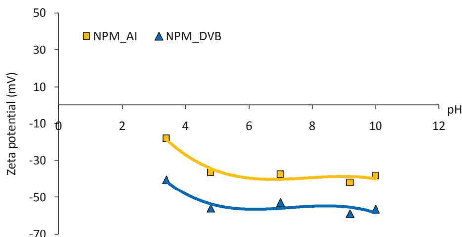
III-5. Potentiels Zeta des particules *NPM\_DVB* et *NPM\_AI* en fonction du pH
