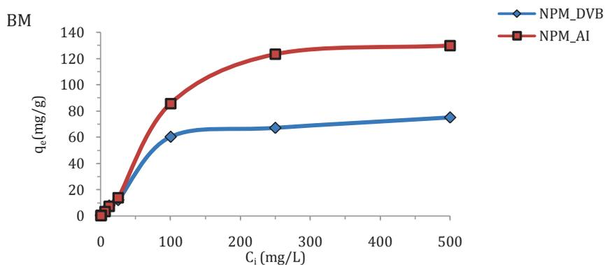
III-7. Effet de la concentration initiale de BM sur l'adsorption de NPM\_DVB et NPM\_AI.
