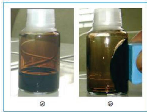
Figure II- 1. Illustration d'un ferrofluide avec ou sans l'action d'un champ magnétique [64].
