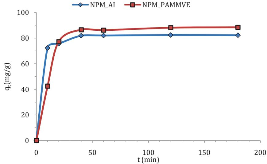
III-16. Effet du temps de contact sur l'adsorption d'ions de Cuivre par NPM\_AI et NPM\_PAMMVE.
