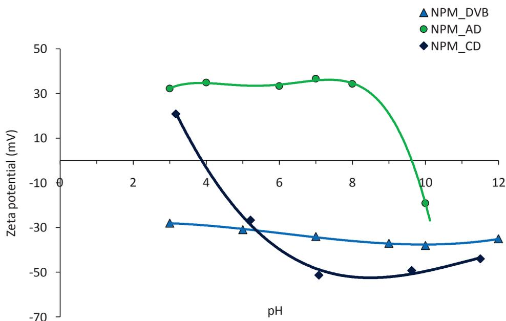
III-4. Potentiels Zeta des particules NPM\_DVB, NPM\_AD et NPM\_CD en fonction du pH
