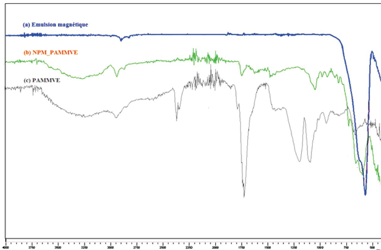
III-8. Spectre infrarouge de (a) émulsion magnétique, (b) NPM\_PAMMVE, et (c) PAMMVE (FTIR, IR Prestige-2, Shimadzu).
