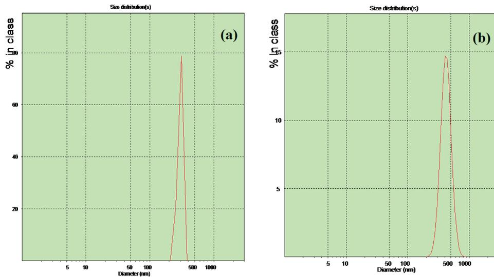
III-3. Répartition de la taille hydrodynamique des particules (a) NPM\_DVB, (b) NPM\_AI.
