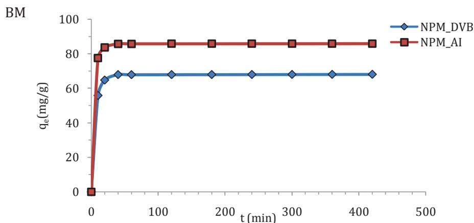
III-5. Effet du temps de contact sur l'adsorption de BM par NPM\_DVB et NPM\_AI.
