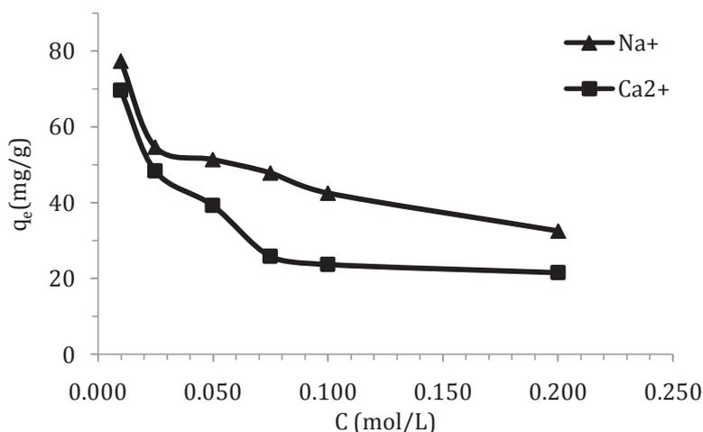
III-15. Effet de la présence de l'ion commun sur l'adsorption d'ions de cuivre par NPM\_PAMMVE.
