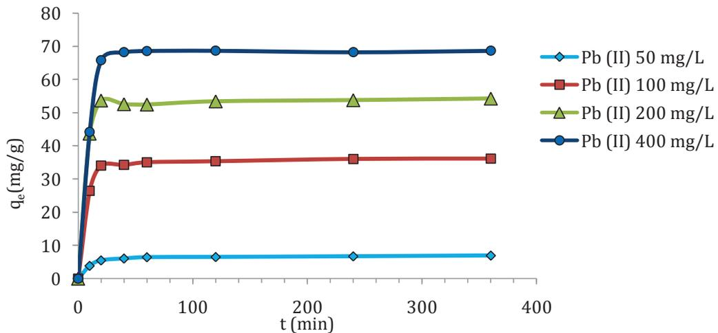
III-10. Cinétique d'adsorption de NPM\_DVB en fonction de la concentration initiale d'ions de plomb.
