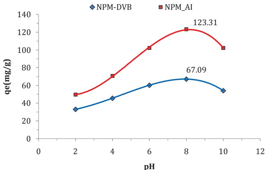
III-3. Effet du pH initial de milieu sur l'adsorption de BM par NPM\_DVB et NPM\_AI.
