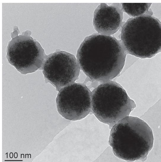
III-2. Observation microscopique électronique à transmission (MET) de NPM\_PMAMVE.
