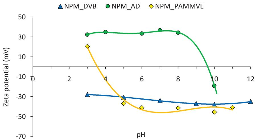
III-6. Potentiels Zeta des particules *NPM\_DVB*, *NPM\_AD*, et *NPM\_PAMMVE* en fonction du pH
