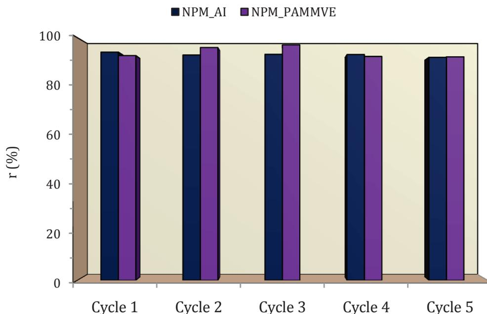
III-18. Taux de récupération de  $\text{Cu(II)}$  au cours de cinq cycles d'adsorption-désorption consécutifs pour le NPM\_AI et NPM\_PAMMVE.
