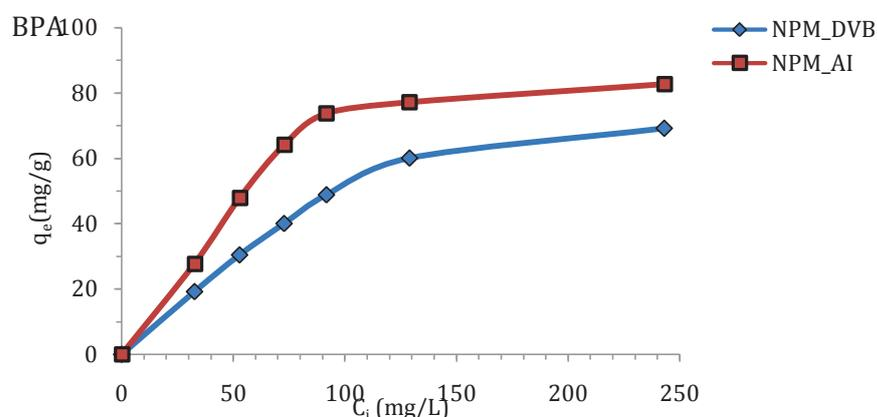
III-8. Effet de la concentration initiale de BPA sur l'adsorption de NPM\_DVB et NPM\_AI.
