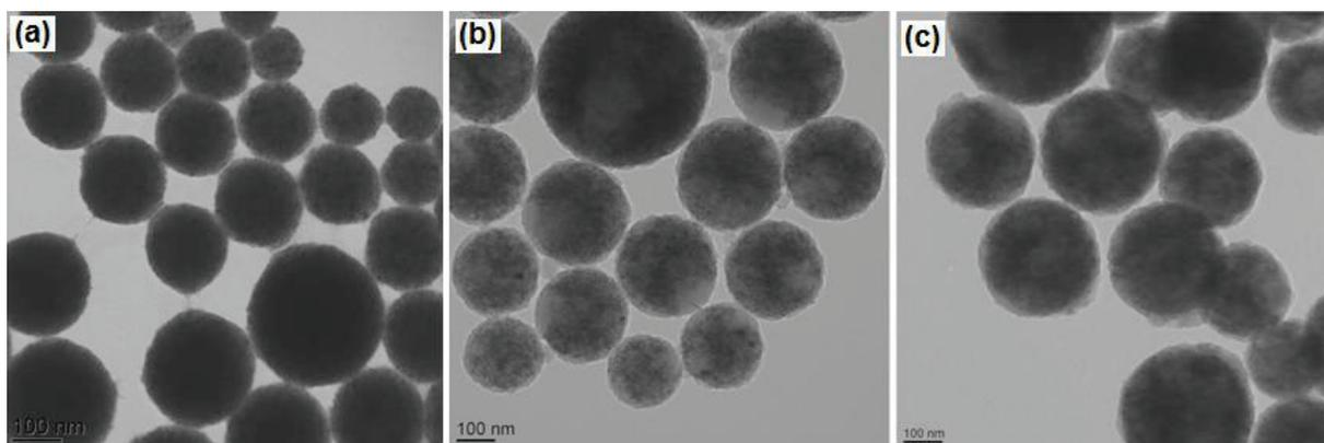
III-1. Observation microscopique électronique à transmission (MET) d'EM (a), NPM\_DVB (b) et NPM-AI (c).
