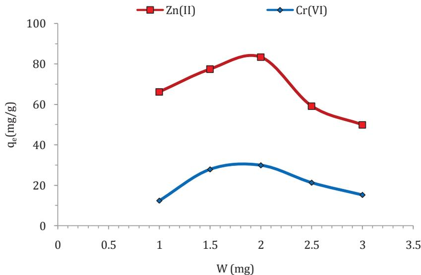
III-12. Effet de la dose de NPM\_PAMMVE sur l'adsorption de Zn(II) et Cr(VI).
