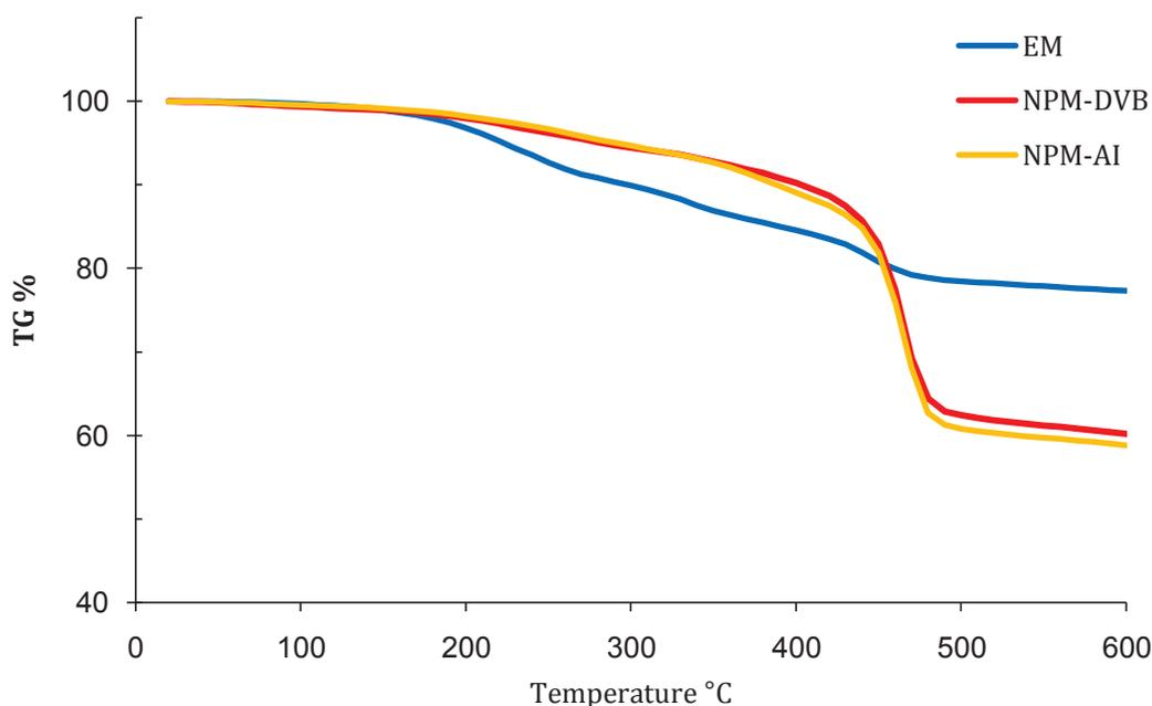
III-9. Variation de masse observée lors de l'analyse thermogravimétrique de l'émulsion magnétique (EM), de NPM\_DVB, et celle de NPM\_AI sous atmosphère N<sub>2</sub> avec une rampe de température de 10°C/min (Netzsch TG 209 F1).
