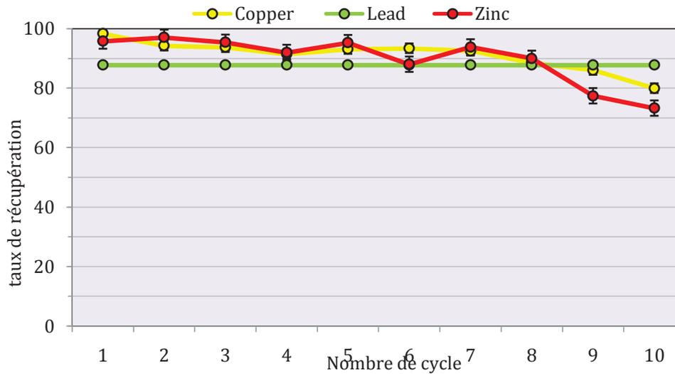
III-14 Taux de récupération de Cu<sup>2+</sup>, Pb<sup>2+</sup> et de Zn<sup>2+</sup> au cours des dix cycles d'adsorption-désorption consécutifs.
