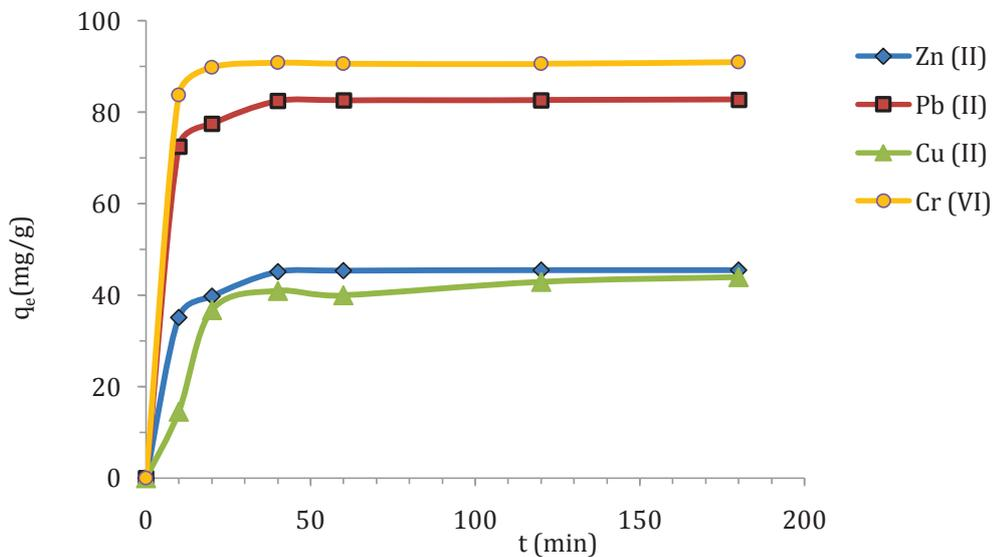
III-9. Effet du temps de contact sur l'adsorption d'ions de Zn (II), Pb (II), Cu (II) et Cr (VI) par NPM\_AD.
