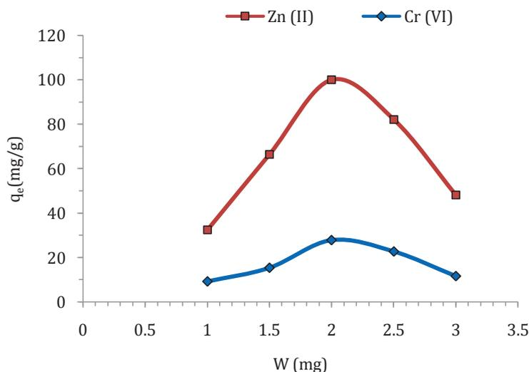
III-11. Effet de la dose de NPM\_AI sur l'adsorption de Zn(II) et Cr(VI)
