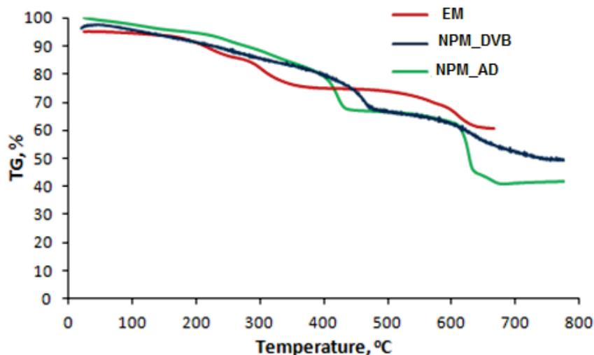
III-5. Variation de masse observée lors de l'analyse thermogravimétrique des MP-DVB, NPM-AD et d'EM sous atmosphère N2 avec une rampe de température de 10°C/min
