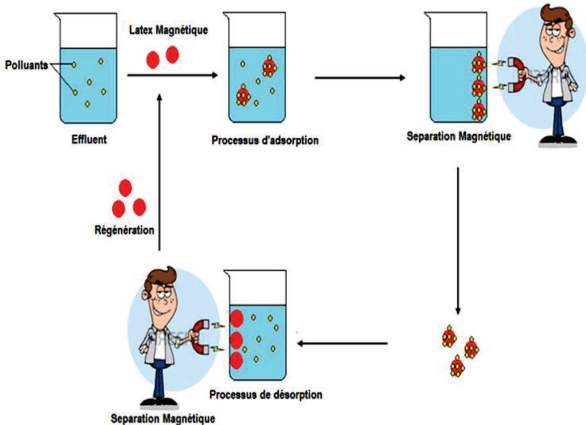
Figure 1. Procédé d'élimination des polluants par des nanoparticules magnétiques fonctionnalisés : adsorption en batch.
