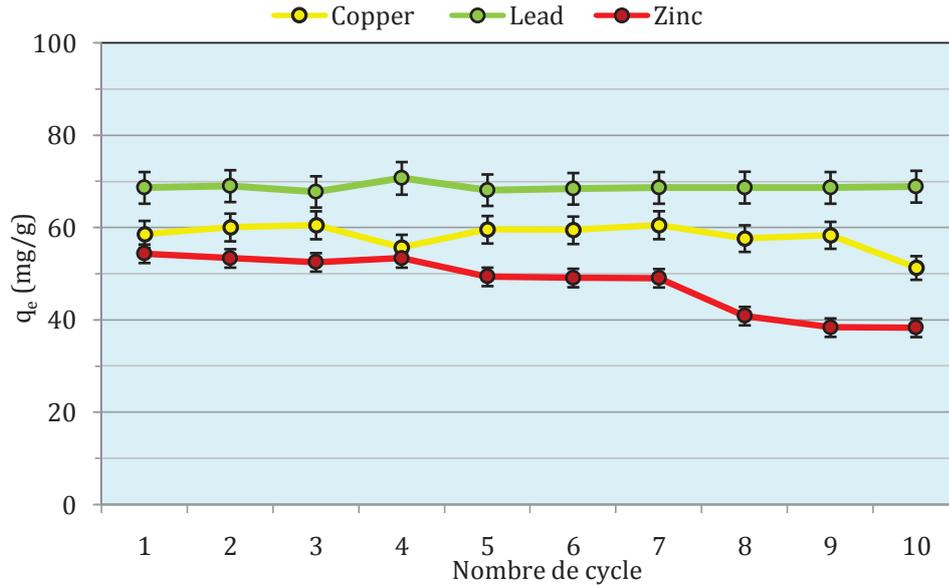
III-13. Capacité d'adsorption de NPM-DVB pour le Cu<sup>2+</sup>, Pb<sup>2+</sup> et de Zn<sup>2+</sup> au cours des dix cycles d'adsorption-désorption consécutifs.
