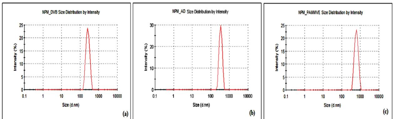
III-4. Répartition de la taille hydrodynamique des particules (a) NPM\_DVB, (b) NPM\_AD, et (c) NPM\_PAMMVE.
