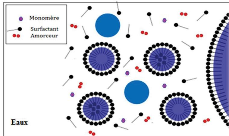
Figure IV- 2. Milieu réactionnel avant polymérisation.
