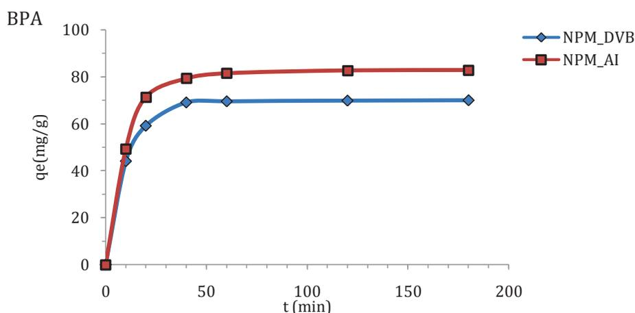
III-6. Effet du temps de contact sur l'adsorption de BPA par NPM\_DVB et NPM\_AI.
