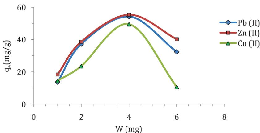
III-7. Effet de la dose de NPM\_DVB sur l'adsorption d'ions de cuivre, plomb et zinc.
