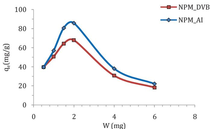
III-1. Effet de la dose de NPM\_DVB et NPM\_AI sur l'adsorption de BM (96 mg/L).
