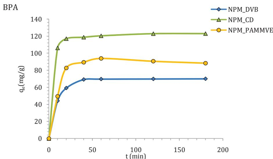
III-6. Aspect cinétique de l'adsorption de BPA par les Latex NPM-DVB, NPM-AI, NPM-AD et NPM-CD ;
