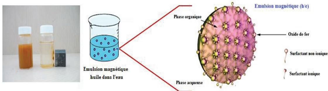
Figure II-1. Représentation schématique de l'émulsion magnétique huile dans l'eau
