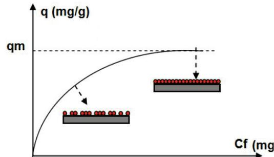
Figure IV- 1. Isotherme d'adsorption de Langmuir.
