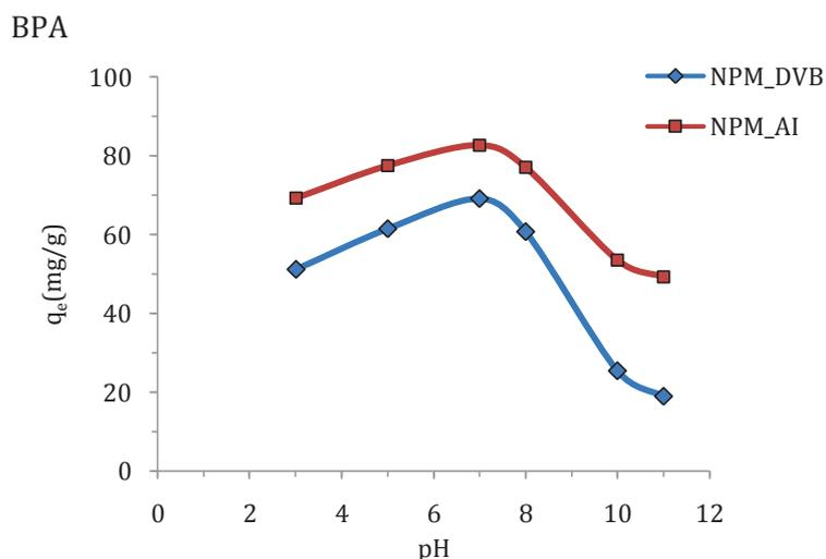
III-4. Effet du pH initial de milieu sur l'adsorption de BPA par NPM\_DVB et NPM\_AI.
