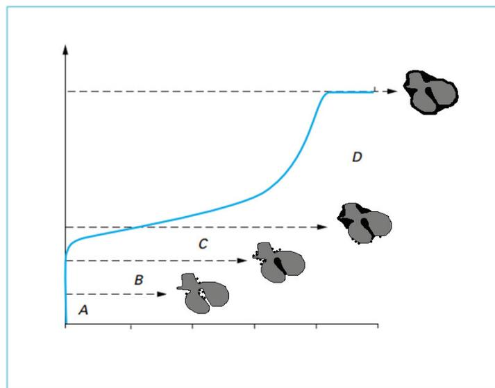
Figure III- 2. Isotherme d'adsorption physique composite (type I + type IV)
