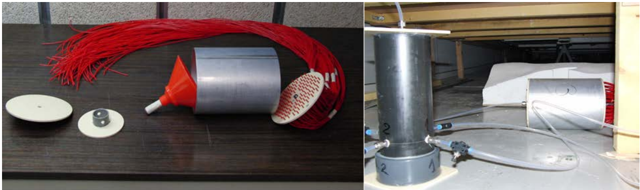
Fig. IV.11. À gauche, distributeur désassemblé. À droite, répartiteur d'éthane raccordé aux quatre distributeurs sous la maquette
