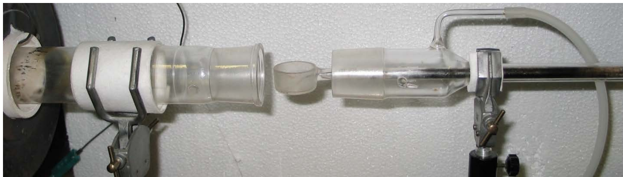
Fig. II.21 photographie de la nacelle à l'intérieur du réacteur
