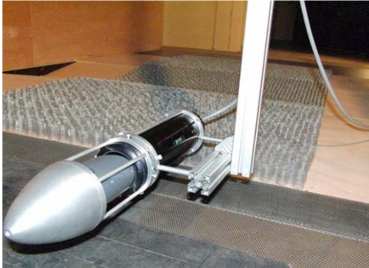
Fig. IV.12. Dispositif LDV suspendu au bras mécanique de la soufflerie
