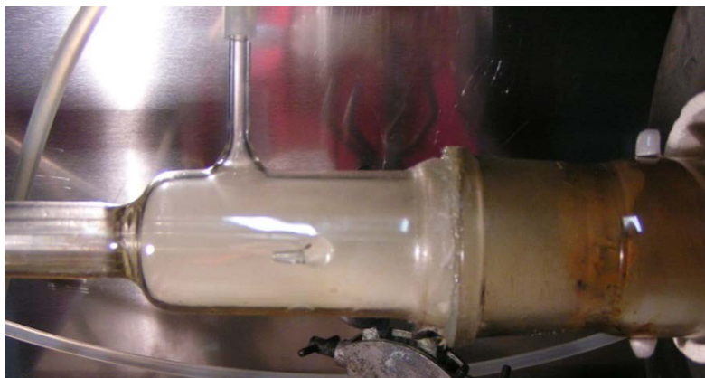
Fig. II.24 Photographie des vapeurs d' \alpha -pinène à l'intérieur du réacteur
