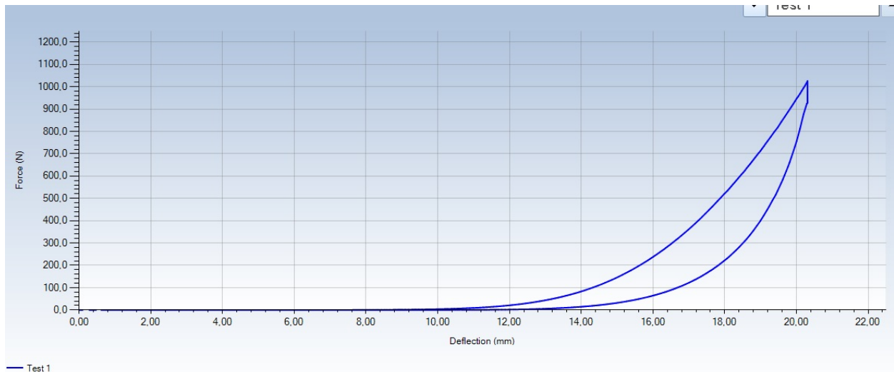
Figure I-15 : Courbe de compressibilité du denim (source : Lectra).
