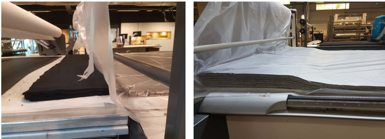
Figure I-14 : Avance du tissu sur la table de coupe et vide d'air.
