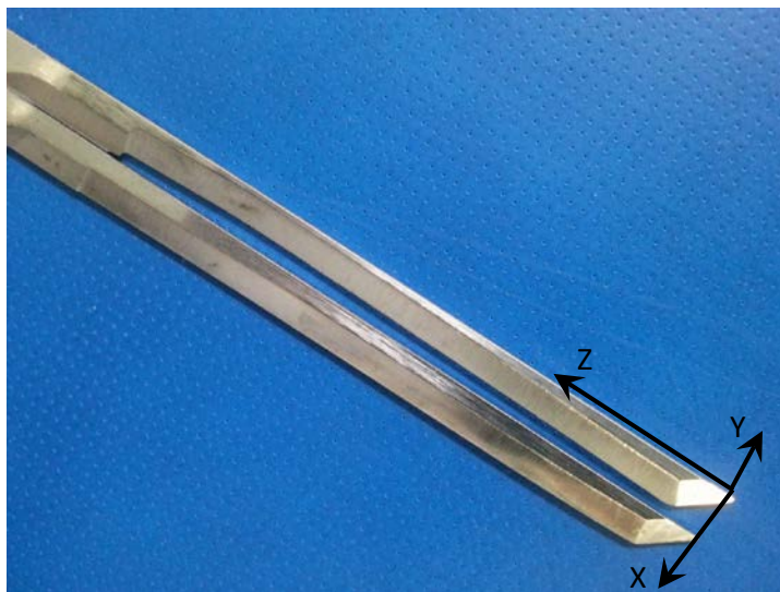
Figure I-20 : Comparaison d'une lame neuve (en bas) et en fin de vie (en haut).
