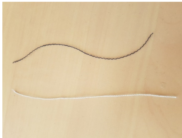
Figure I-7 : Fil de chaîne teinté au-dessus, fil de trame écru au-dessous.
