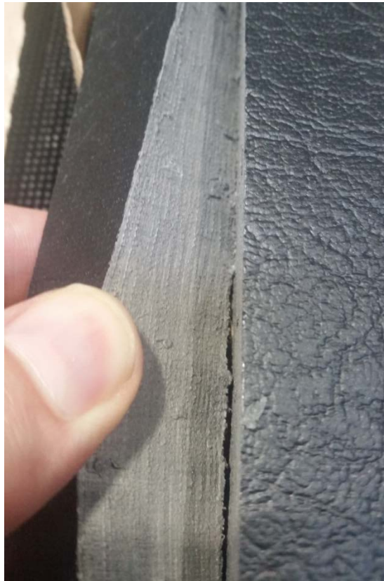
Figure I-28 : Coupe de vinyl : présence de plis fondus suite à une fréquence de coupe trop élevée.
