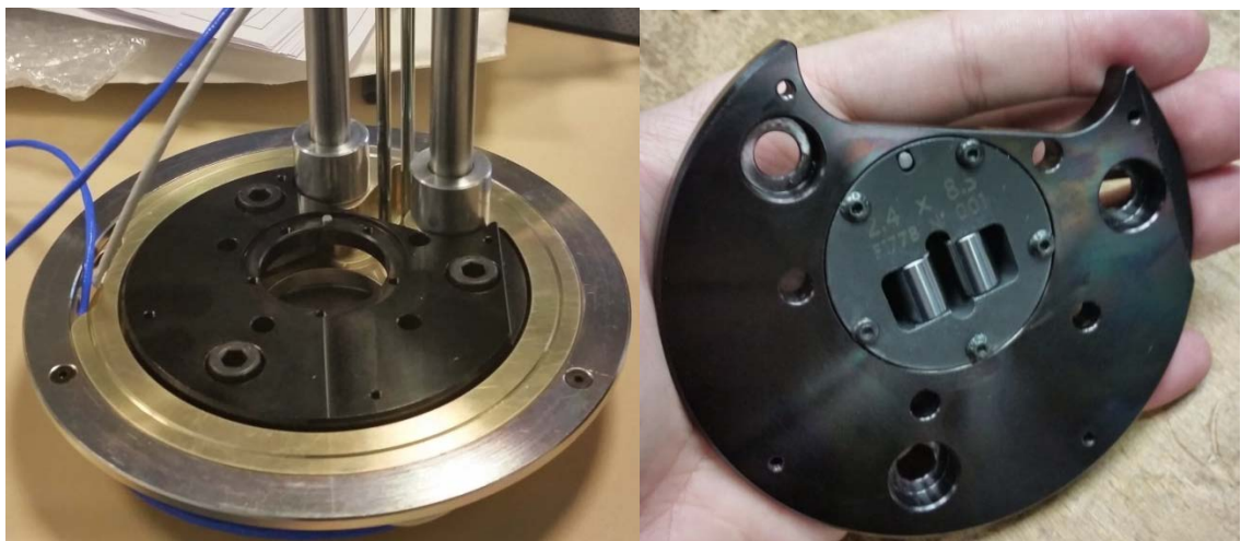
Figure II-10 : Dynamomètre fermé et porte galet intégré.
