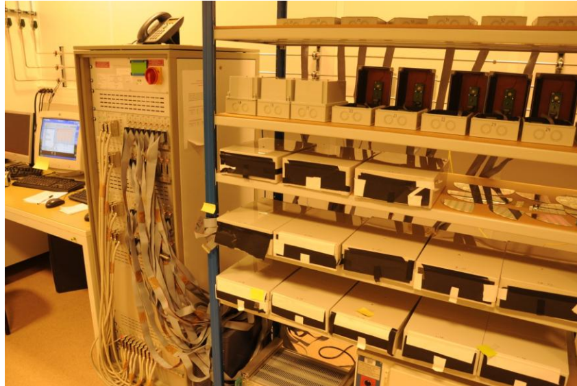
Fig. 3.24. Photo du banc de test principal de DDV (avec à gauche l'ordinateur utilisé pour gérer le logiciel pilotant toutes les boîtes indépendamment, au milieu le bloc des sources d'alimentation en courant et au premier plan à droite les boîtes de DDV).
