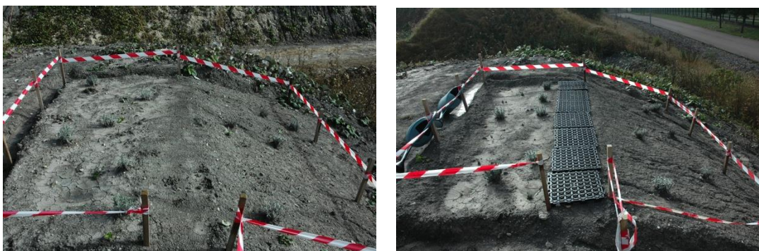
Figure 15 : Dispositif d'essai de végétalisation de lavande sur verse âgée à l'Est (à gauche) et au Sud avec accès protégé et une allée recouverte de caillebotis escamotables (à droite) 62 jours après plantation
