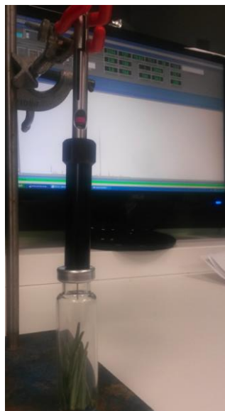
Figure 19: Dispositif de la micro-extraction sur phase solide en place avec un échantillon foliaire de lavandin
