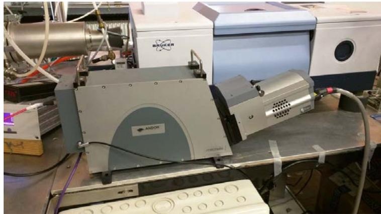
FIGURE II.16 – Photo du spectromètre visible ANDOR Mechelle
