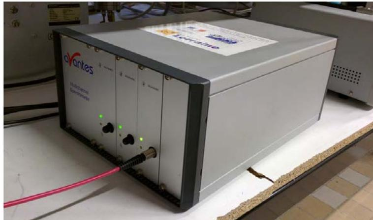
FIGURE II.14 – Photo du spectromètre visible Avantes
