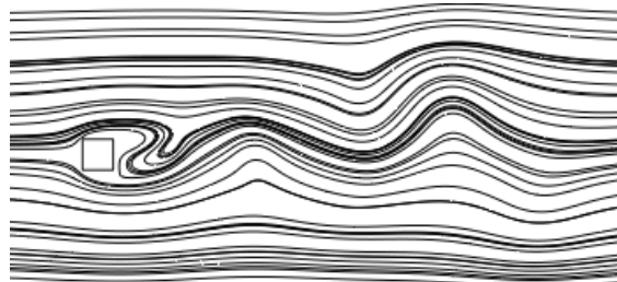
Figure 2.8: Représentation des lignes de courant pour Re=10^3 et à t=25\text{sec} .
