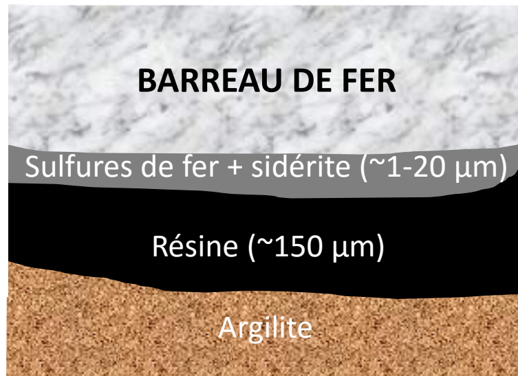
Figure IV-17 : schéma du faciès de corrosion de l'échantillon CBCC
