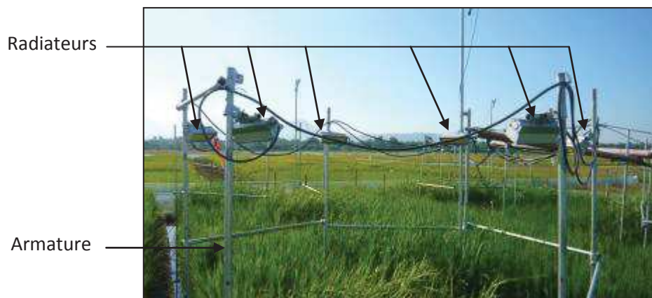
Image 3 : Dispositif T-FACE au champ à l'IRRI (Philippines).
