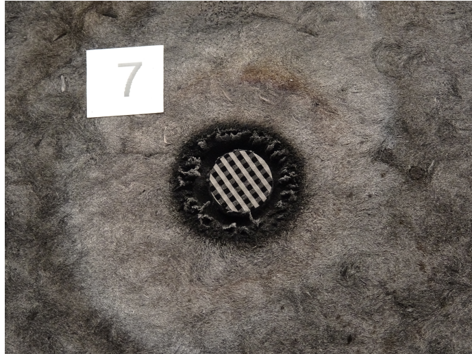
FIGURE 4.1 – Photo d'un échantillon dans son porte échantillon après un test de sublimation au four à image d'arc du CEA/CESTA.
