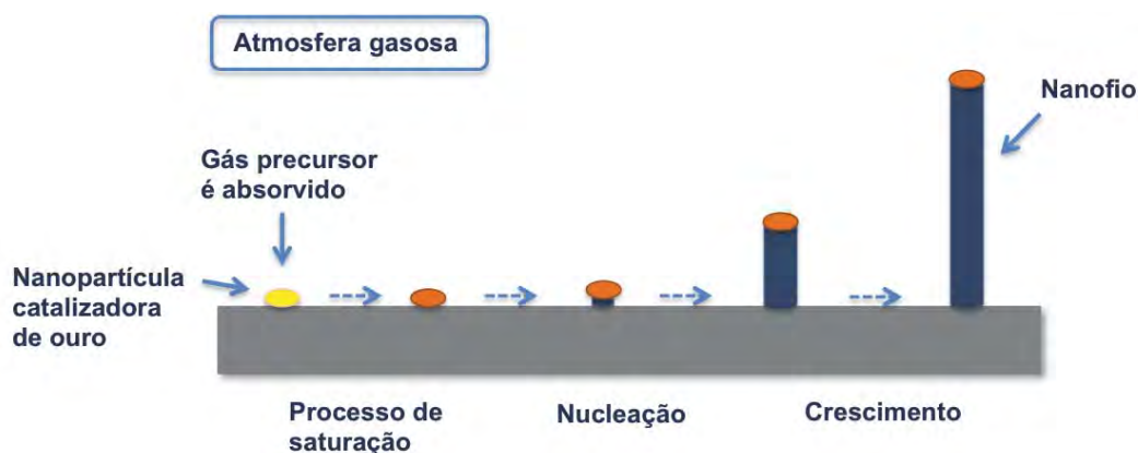
Figura 2.2: Figura esquemática do processo de crescimento de um nanofio por CVD.
