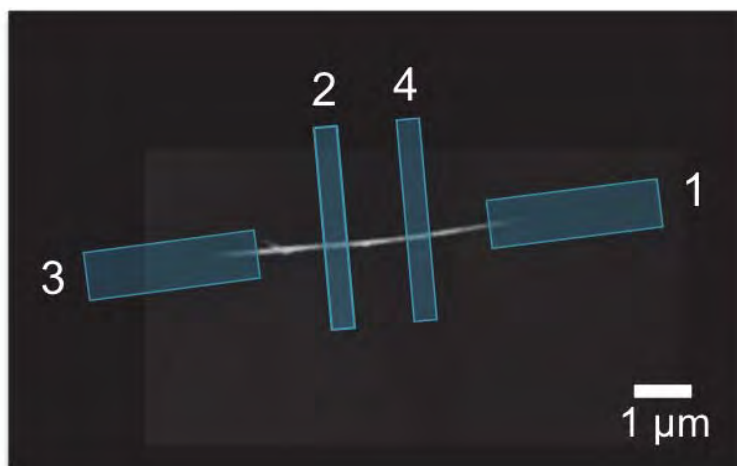
Figura 5.3: Imagem de um fio de Co de pH 6 com esquema dos quatro contatos fabricados.
