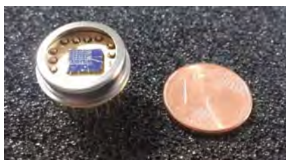
Figure 4.21: Echantillon monté en boîtier pour l'utilisation de la station des mesures sous atmosphère gazeuse.
