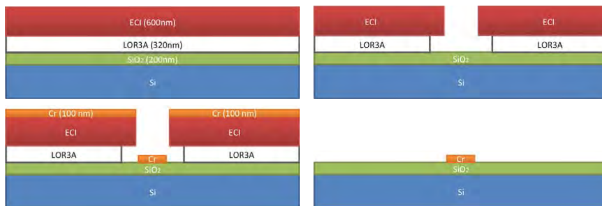
Figura 3.13: Visão lateral do processo, esquemático, de fabricação dos eletrodos.
