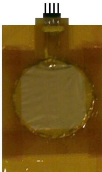
Figura 3.3: A membrana fixa ao suporte e envolta pela fita Kapton, a qual permite a exposição à solução apenas a região de interesse da membrana.
