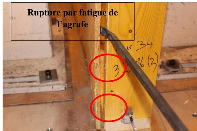
Figure III-63 : Rupture par fatigue de l'agrafe
