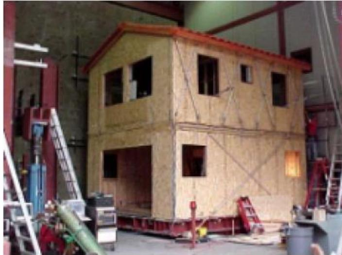
Figure V-19 : Photo de la structure à deux niveaux testée à l'Université de San Diego (Camelo, 2003)
