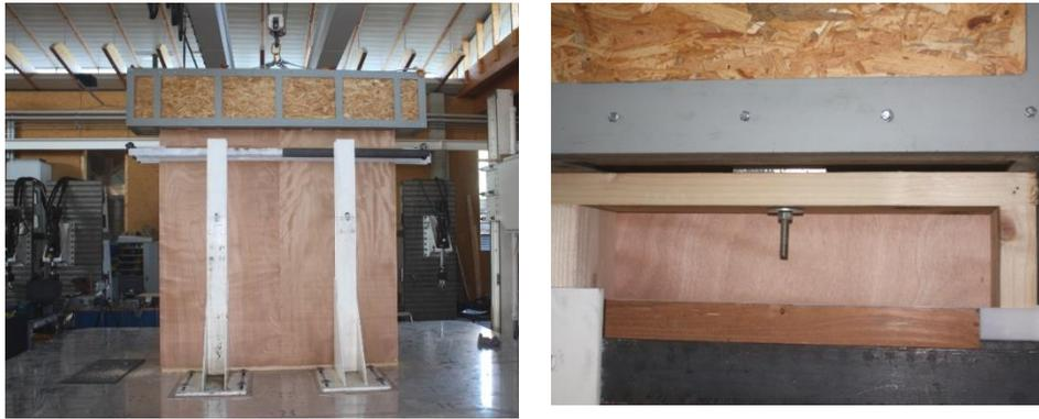
**Figure III-49 :** (a) Élément de mur à ossature en bois fixé sur la table vibrante et chargé verticalement, (b) fixation de la charge verticale
