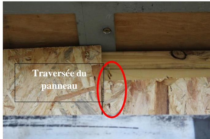
Figure III-61 : Rupture par traversée de la tête d'agrafe du panneau
