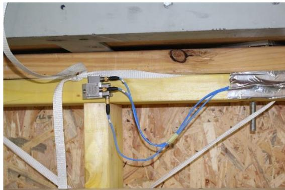
**Figure III-51 :** Gros plan des accéléromètres mis en place sur la lisse d'un élément de murs à ossature bois
