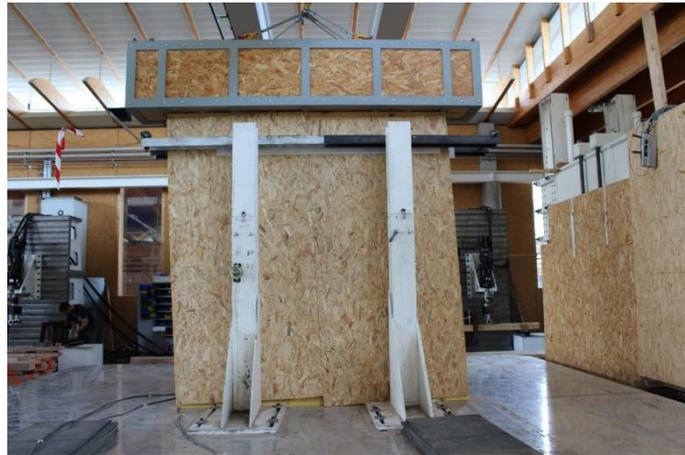
**Figure III-64 :** Etat d'endommagement d'un mur à ossature en bois à la fin du déroulement d'un essai dynamique
