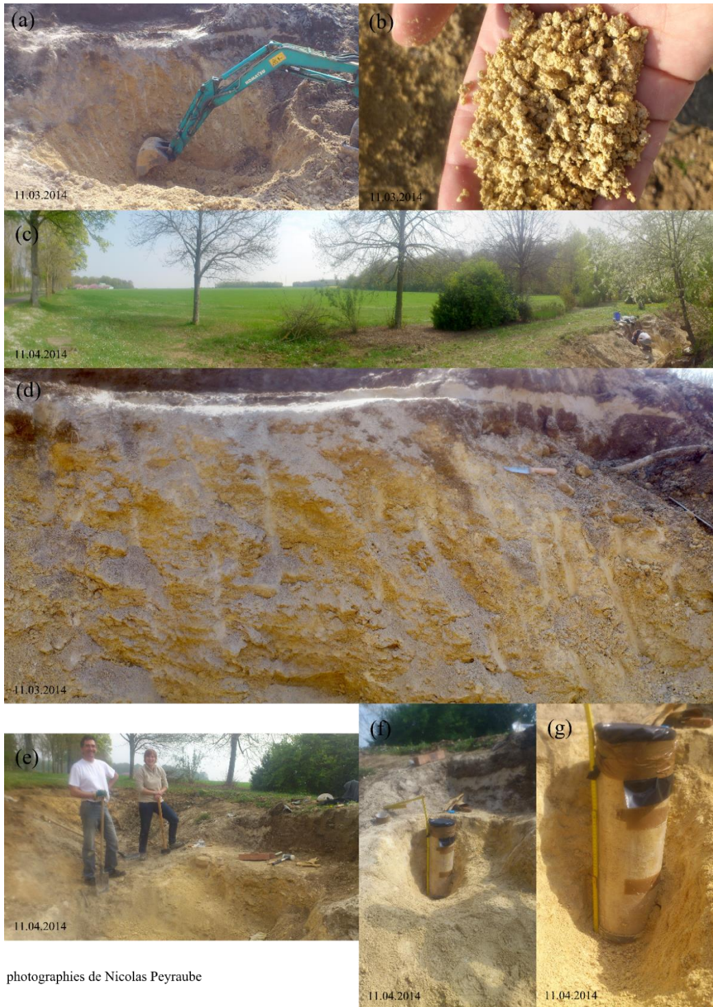
(a) ouverture de la fosse, (b) zoom du matériau, (c) zone d'étude, (d) zoom sur le profil de la fosse, (e) haut les cœurs, il est l'heure de creuser, (f) colonne 10 de 60 cm de longueur, (g) zoom sur la colonne 10.
