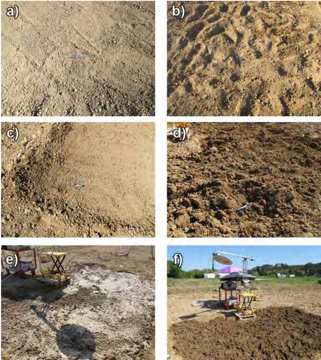
Figure 37 - Photographies de la surface du terrain de mesure pour différentes conditions d'humidité du sol et de rugosité de surface. Le stylo bleu permet de rendre compte des proportions.
