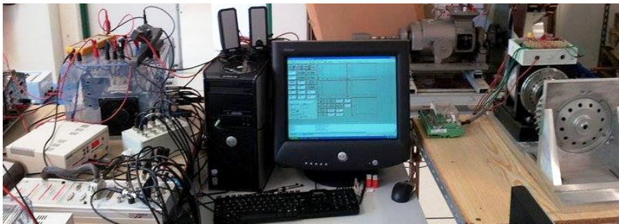
FIGURE A.1 – Photo banc d'essai utilisé pour simuler les défauts intermittents sur la Machine 1
