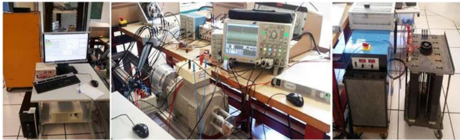
FIGURE A.2 – Photo banc d'essai utilisé pour simuler les défauts intermittents sur la Machine 2
