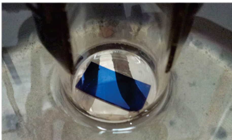
Figure 2.8 : Photographie d'une plaque de silicium de 2 cm 2 après 90 minutes de dépôt en phase vapeur d'un mélange Mo(CO) 6 /DMDS à 150°C dans le réacteur de génération 1. Le thiolate déposé est brun (visible sur les parois du réacteur), mais apparaît en bleu sur le wafer de silicium (initialement gris) en raison des interférences liées à l'épaisseur de la couche déposée.
