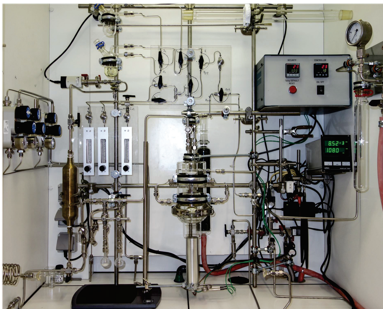
Figure 4.3 : Photographie du réacteur de CVD/ALD (réacteur de génération 2) monté au laboratoire C2P2 (la pompe et le four de recuit sont placés sous la paillasse).
