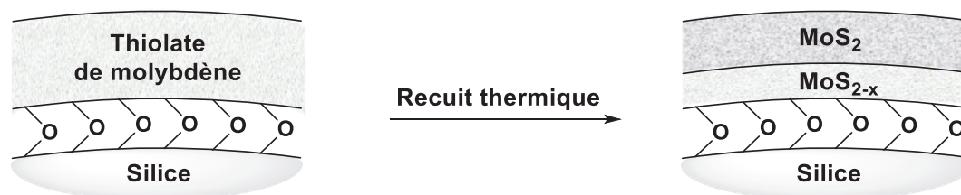
Figure 3.25 : Suggestion de structure pour le dépôt de sulfure de molybdène obtenu après recuit compte tenu des compositions élémentaires et des analyses TEM.
