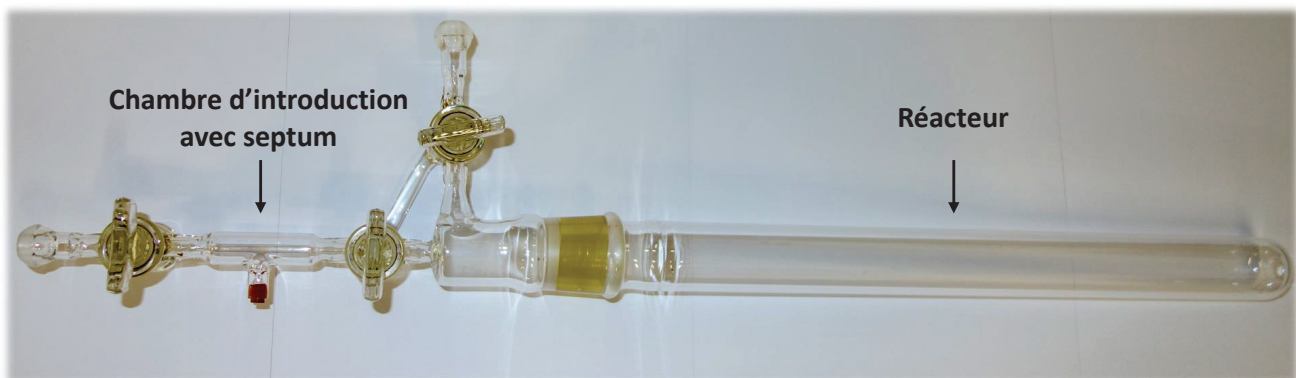
Figure 4.13 : Photographie du réacteur utilisé pour le dépôt par ALD sur silice en poudre.
