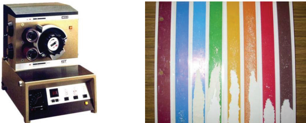
Figure 44. Presse IGT modèle AIC2-5 et exemples de test d'arrachage avec des encres à tirant gradué
