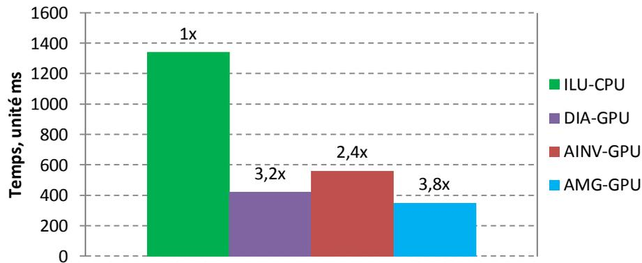
Figure III.26 Comparaison du temps du solveur CG avec les préconditionneurs différents
