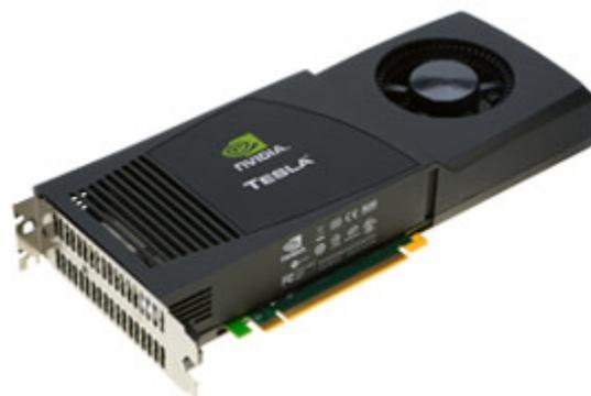
Figure I.2 GPU NVIDIA Tesla C1060 possède 240 processeurs, une puissance de calcul de 933 GFLOPS en simple précision (32 bits), une bande passante mémoire de 102 GB/s
