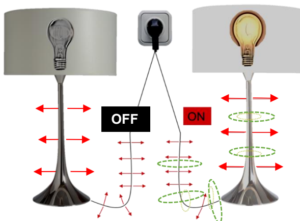
Figure 1 : Champ électrique et champ magnétique
