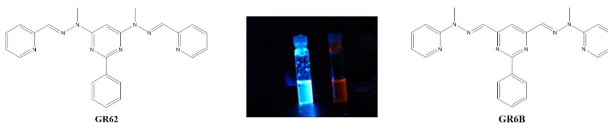
Figure 5: Les couleurs différentes de lumière émise par deux grilles simples avec une symétrie différente de la liaison hydrazone.
