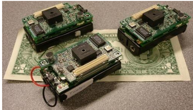
Figure 3 : Exemple de capteur intelligent MICA2 de Crossbow [17]
