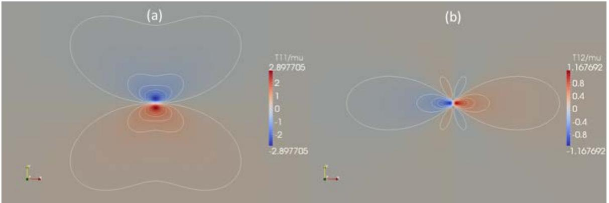
FIGURE 3.5 – Contours des contraintes : (a)  $T_{11}$  et (b)  $T_{12}$  normalisées par  $\mu$  pour une dislocation coin obtenue par la présente méthode FFT avec  $1024 \times 1024$  pixels.
