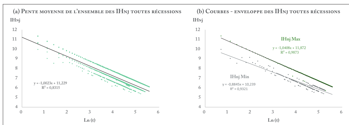
FIGURE 7.6 : DÉTERMINATION DES COURBES-ENVELOPPE DU MODÈLE DE VIDANGE DE L'AQUIFÈRE À MASSILARGUES-ATTUECH
