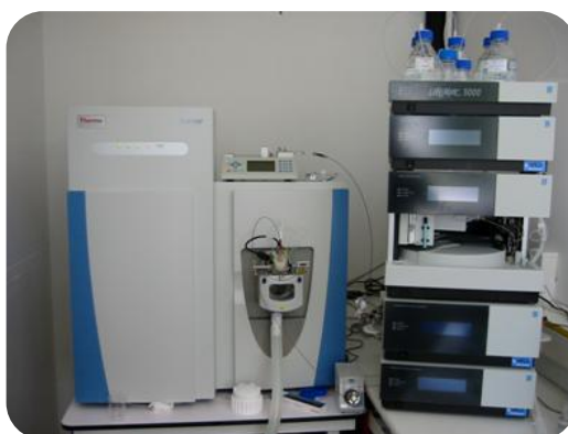
Figure 1: Chaîne de chromatographie liquide UHPLC Dionex Ultimate 3000 (à droite sur la photo) couplée au spectromètre de masse Thermo Exactive (à gauche sur la photo).
